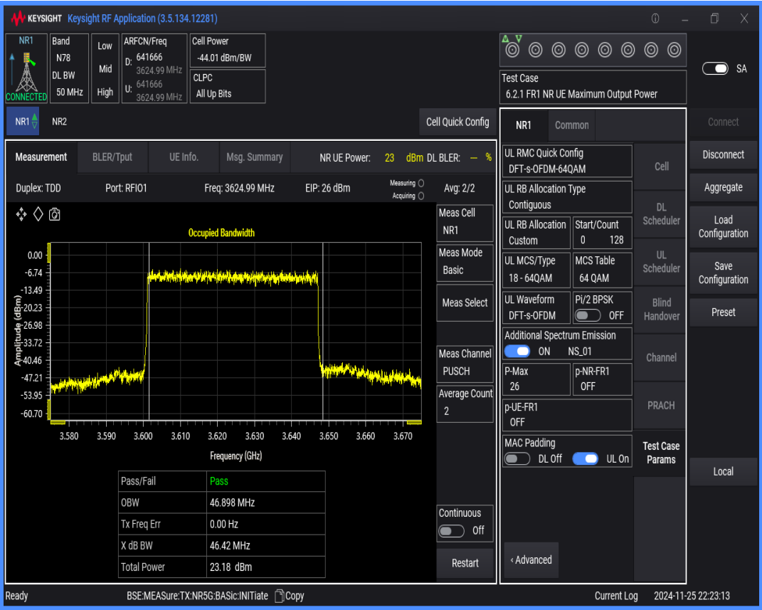
n78(3550-3700) SCS=30kHz DFT_QAM64 BW=20MHz Channel=641666 RB=50@0
