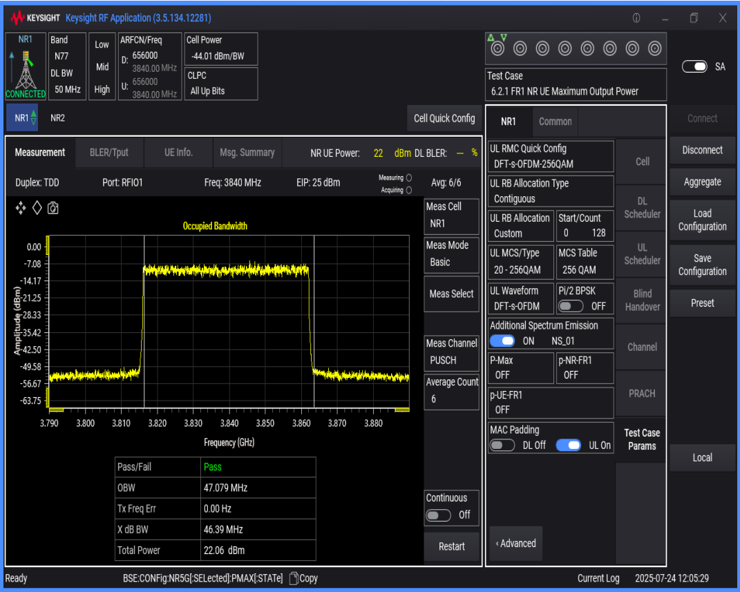
n77(3700-3980) SCS=30kHz DFT_QAM256 BW=20MHz Channel=656000 RB=50@0
