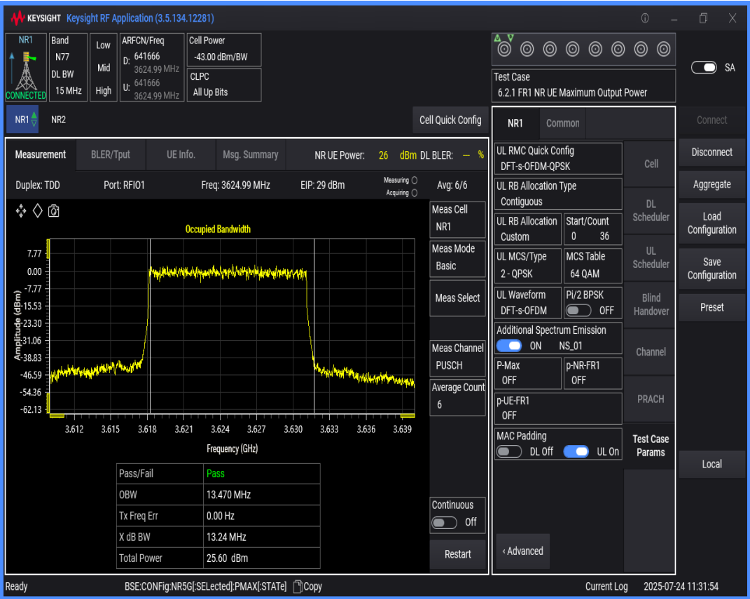
n77(3550-3700) SCS=30kHz DFT_QPSK BW=20MHz Channel=641666 RB=50@0
