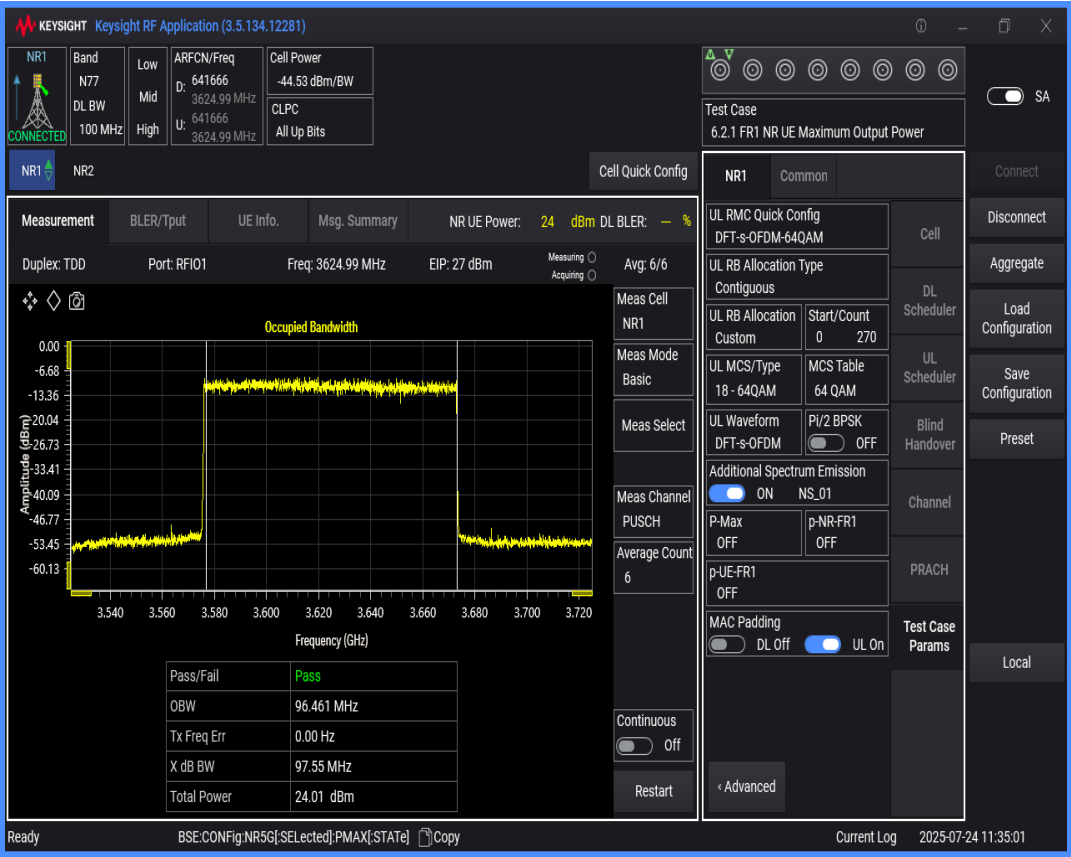
n77(3550-3700) SCS=30kHz DFT_QAM64 BW=20MHz Channel=641666 RB=50@0
