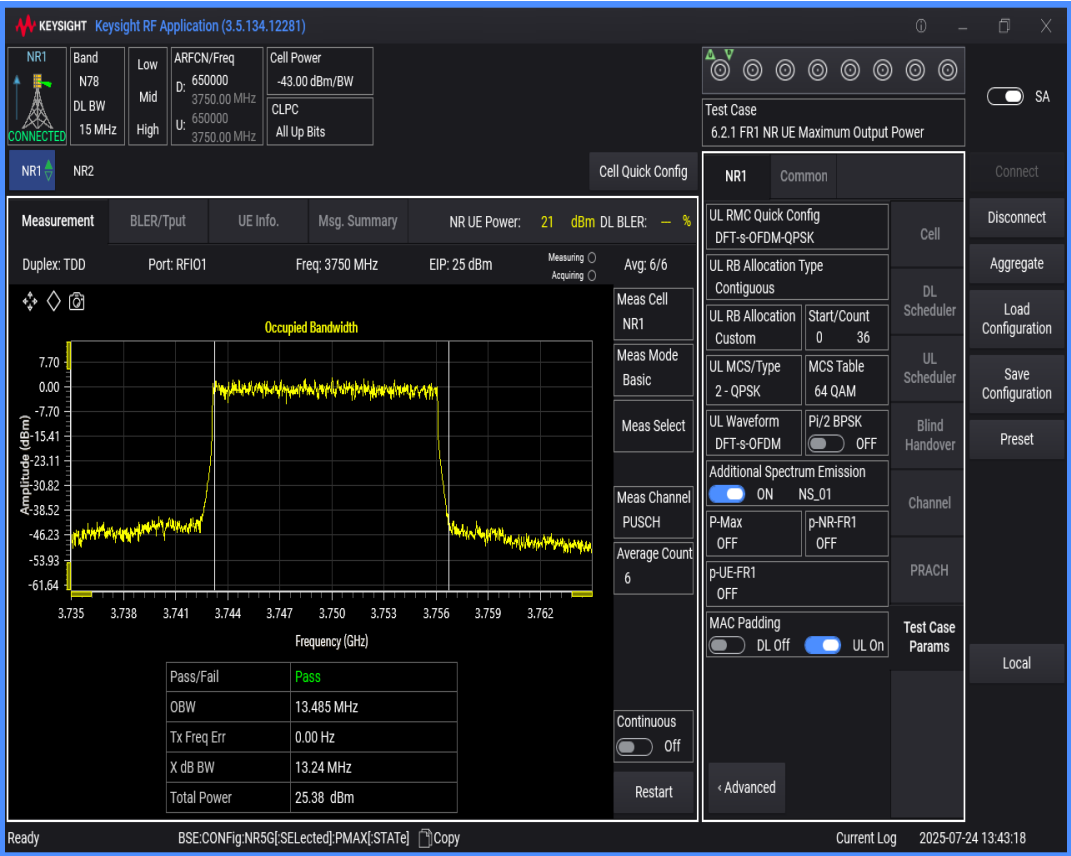
n78(3700-3800) SCS=30kHz DFT_QPSK BW=20MHz Channel=650000 RB=50@0
