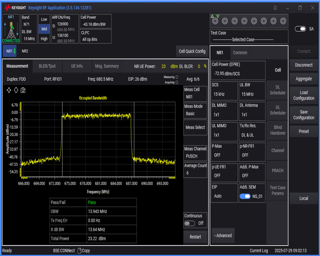
n71 SCS=15kHz DFT_QAM16 BW=10MHz Channel=136100 RB=50@0
