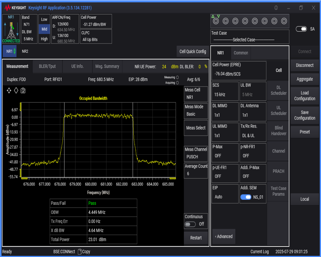
n71 SCS=15kHz DFT_QAM256 BW=10MHz Channel=136100 RB=50@0
