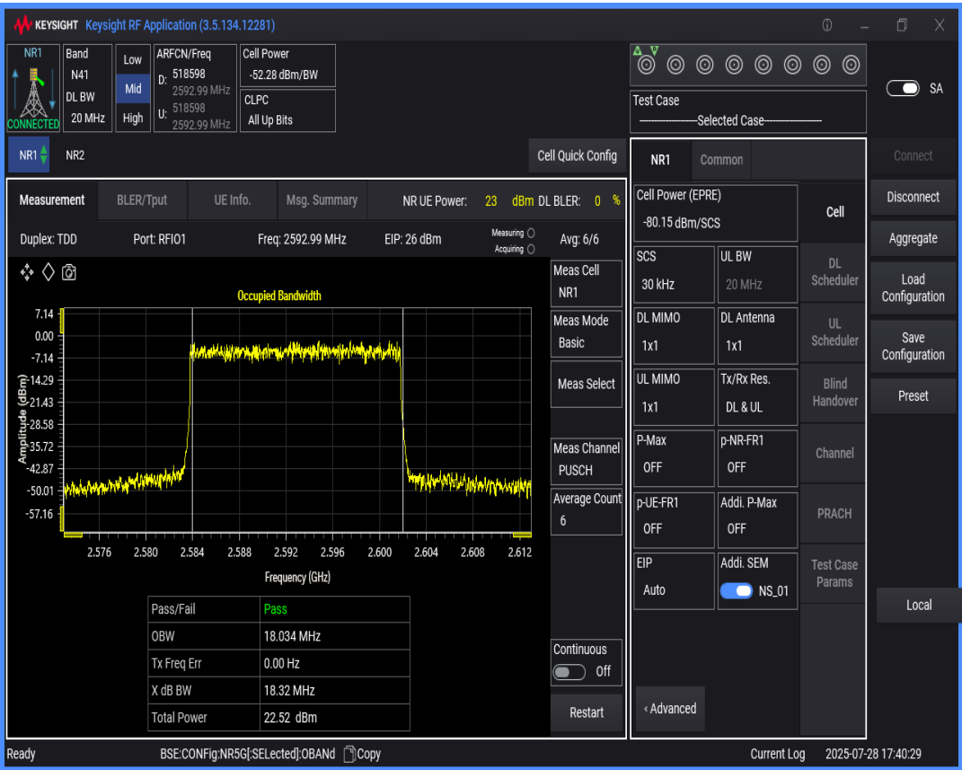
n41 SCS=30kHz DFT_QPSK BW=20MHz Channel=518598 RB=50@0
