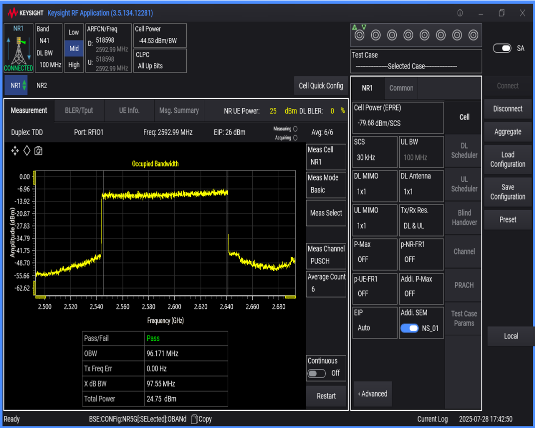
n41 SCS=30kHz DFT_BPSK BW=20MHz Channel=518598 RB=50@0
