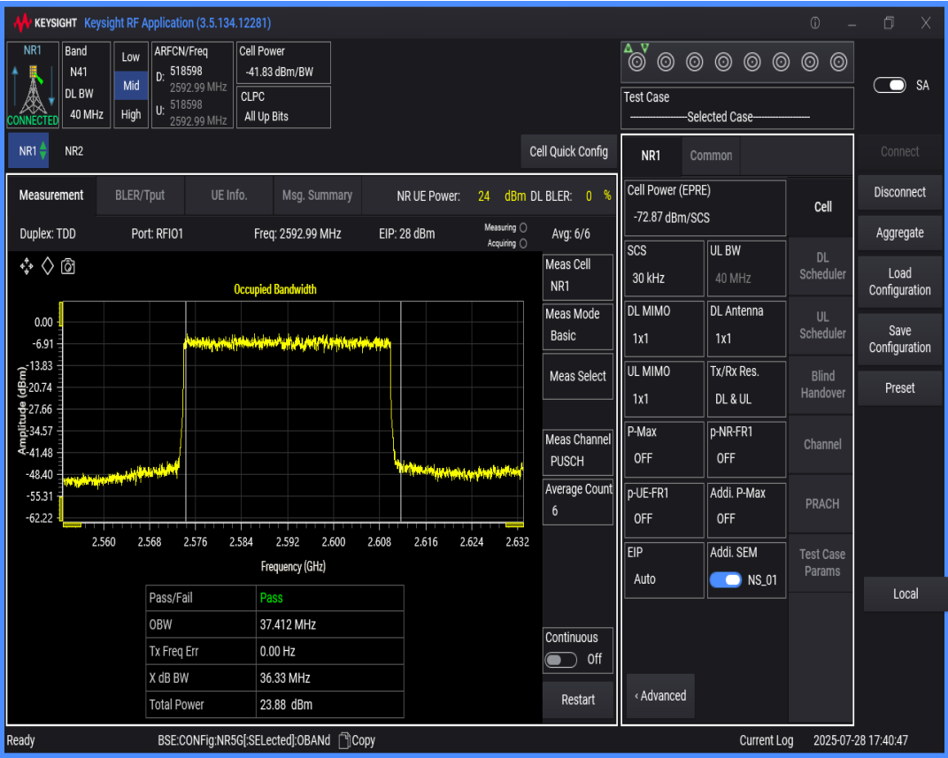
n41 SCS=30kHz DFT_QPSK BW=50MHz Channel=518598 RB=128@0
