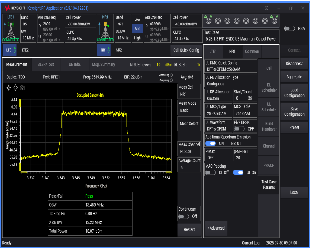
n78 SCS=30kHz DFT_QAM256 BW=20MHz Channel=636666 RB=50@0
