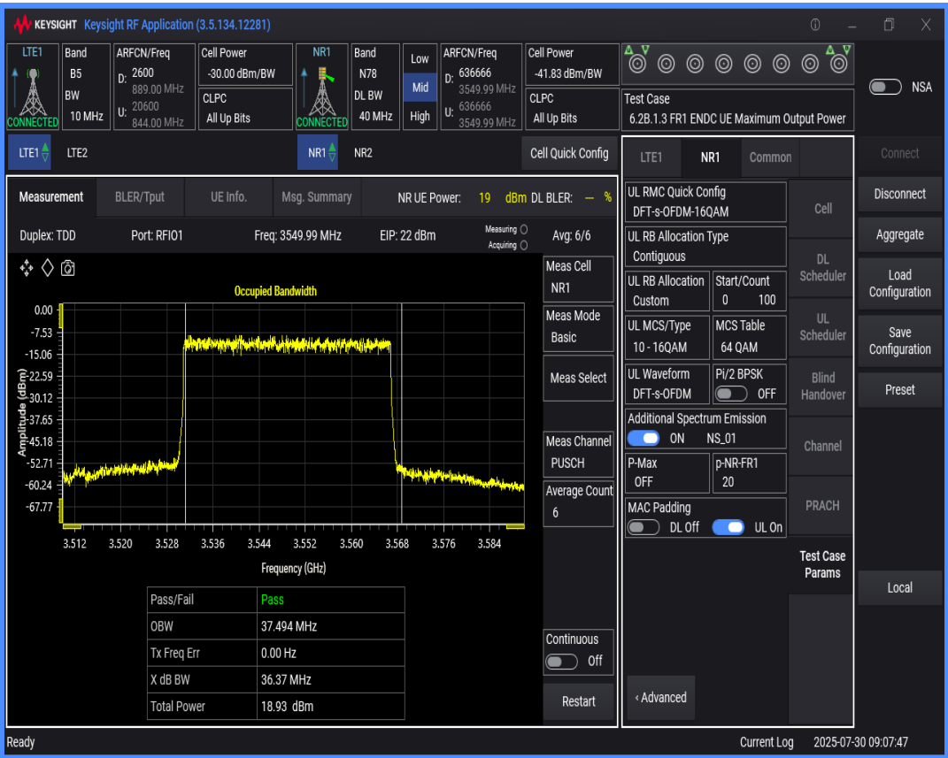
n78 SCS=30kHz DFT_QAM16 BW=20MHz Channel=636666 RB=50@0
