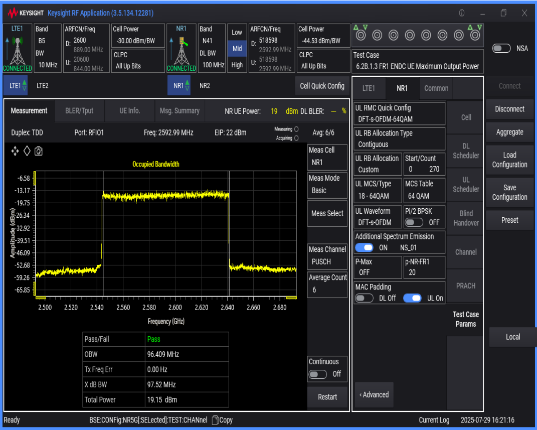
n41 SCS=30kHz DFT_QAM64 BW=20MHz Channel=518598 RB=50@0
