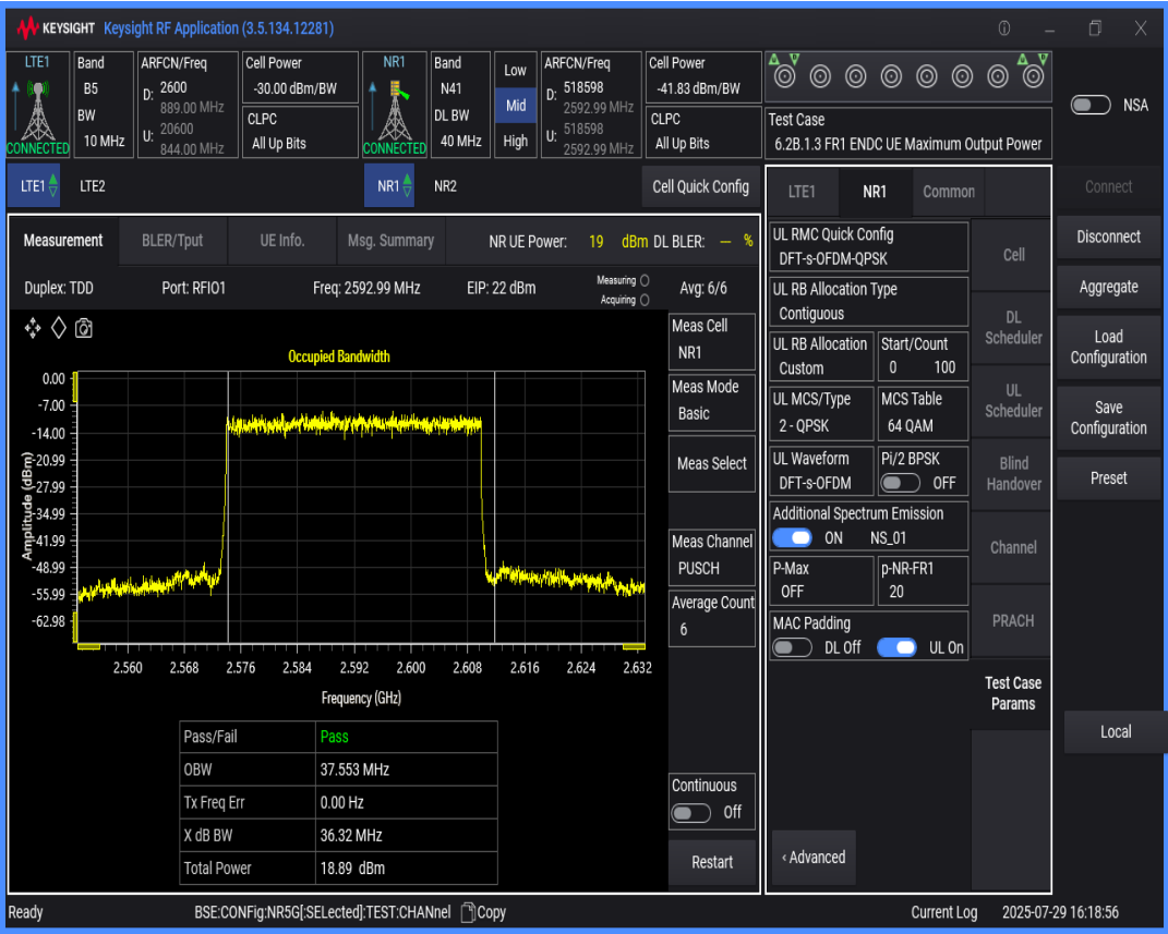
n41 SCS=30kHz DFT_QPSK BW=50MHz Channel=518598 RB=128@0
