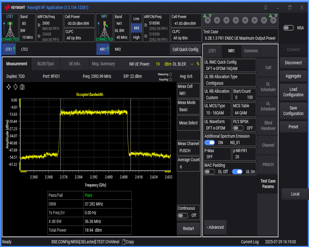
n41 SCS=30kHz DFT_QAM16 BW=20MHz Channel=518598 RB=50@0
