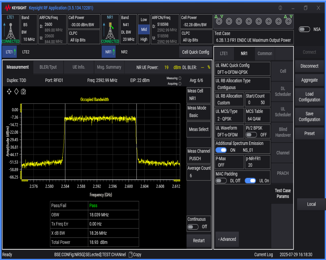
n41 SCS=30kHz DFT_QPSK BW=40MHz Channel=518598 RB=100@0
