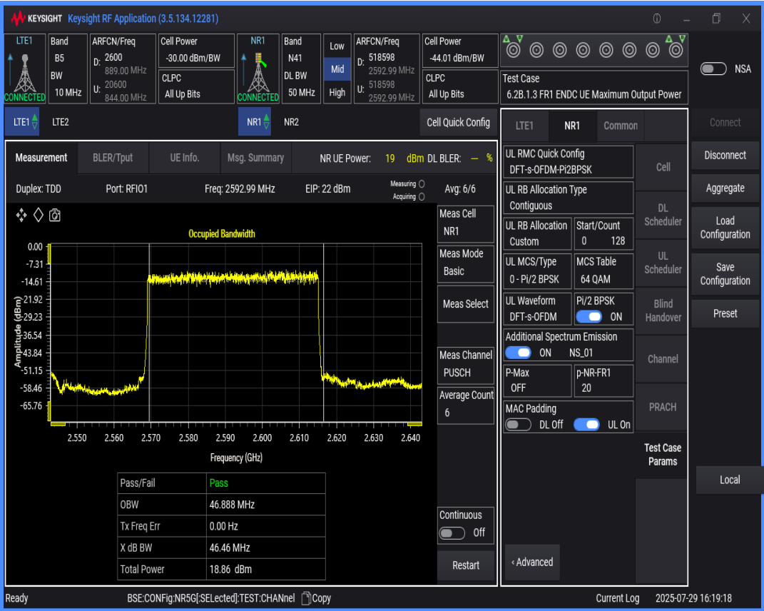
n41 SCS=30kHz DFT_BPSK BW=40MHz Channel=518598 RB=100@0
