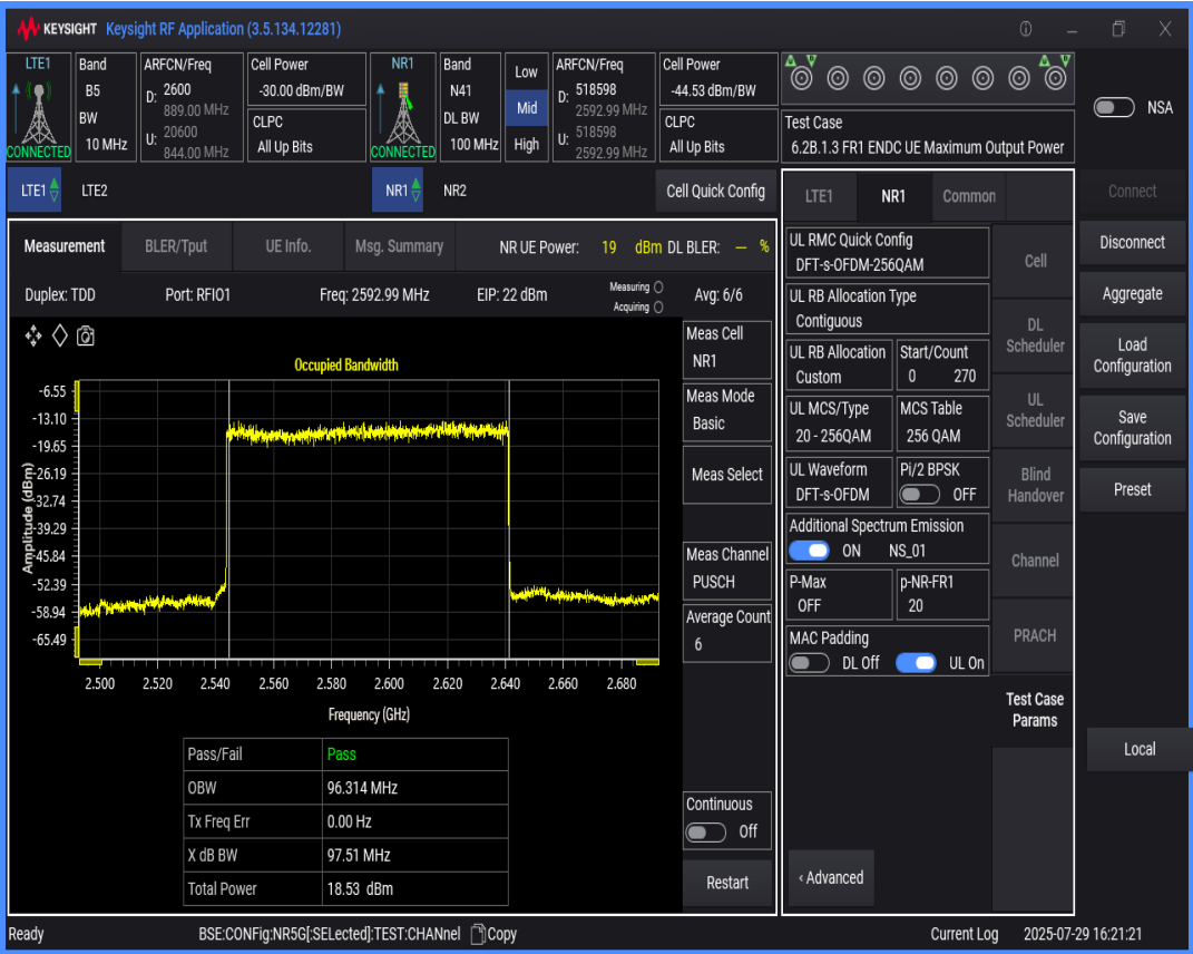
n41 SCS=30kHz DFT_QAM256 BW=20MHz Channel=518598 RB=50@0
