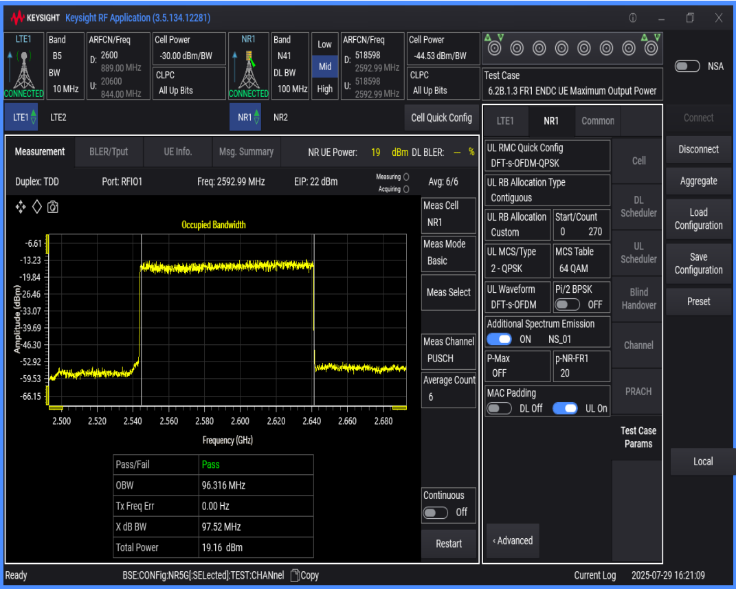
n41 SCS=30kHz DFT_QPSK BW=90MHz Channel=518598 RB=240@0
