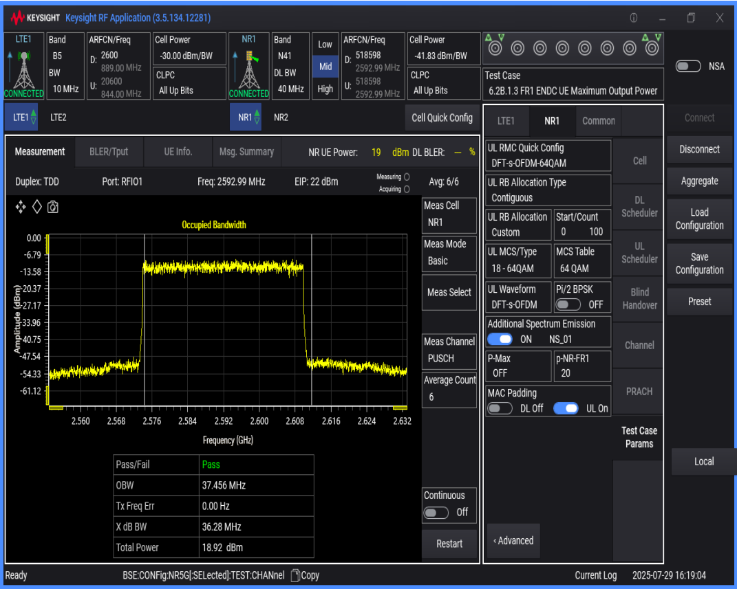
n41 SCS=30kHz DFT_QPSK BW=20MHz Channel=518598 RB=50@0
