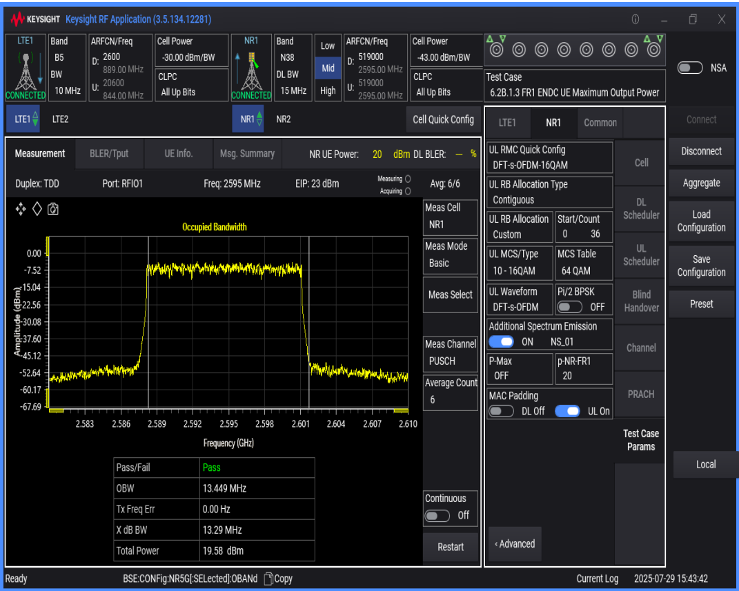
n38 SCS=30kHz DFT_QAM16 BW=20MHz Channel=519000 RB=50@0
