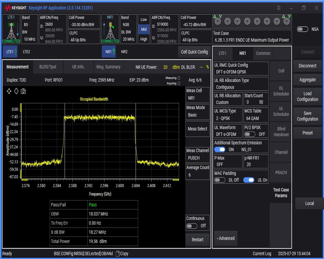
n38 SCS=30kHz DFT_QPSK BW=10MHz Channel=519000 RB=24@0
