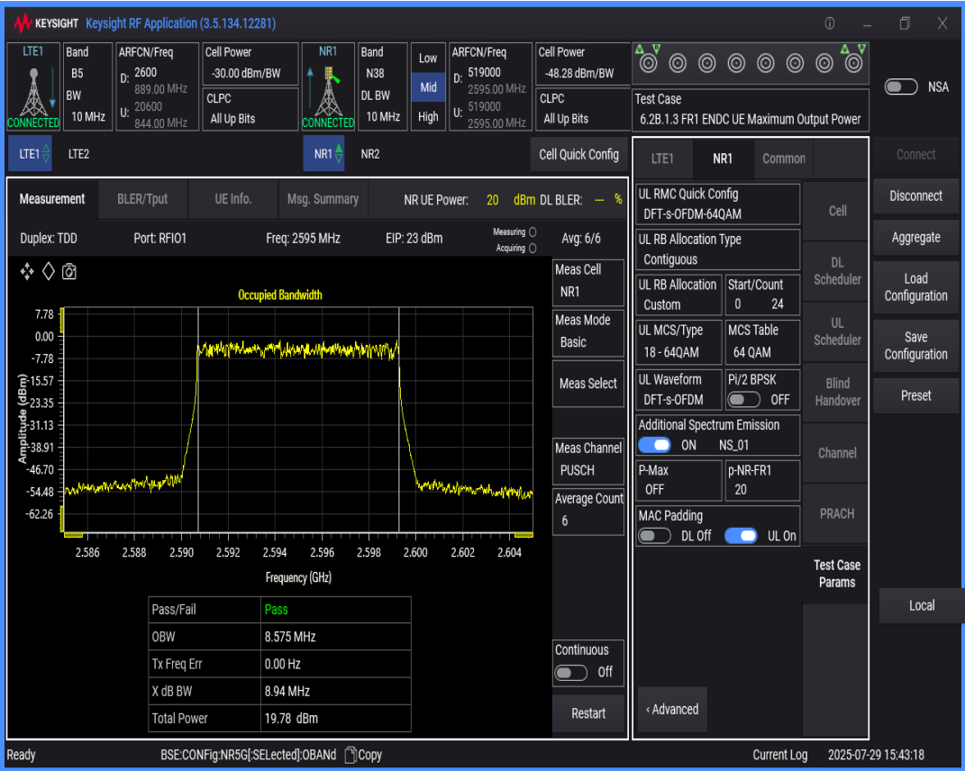
n38 SCS=30kHz DFT_QAM256 BW=10MHz Channel=519000 RB=24@0
