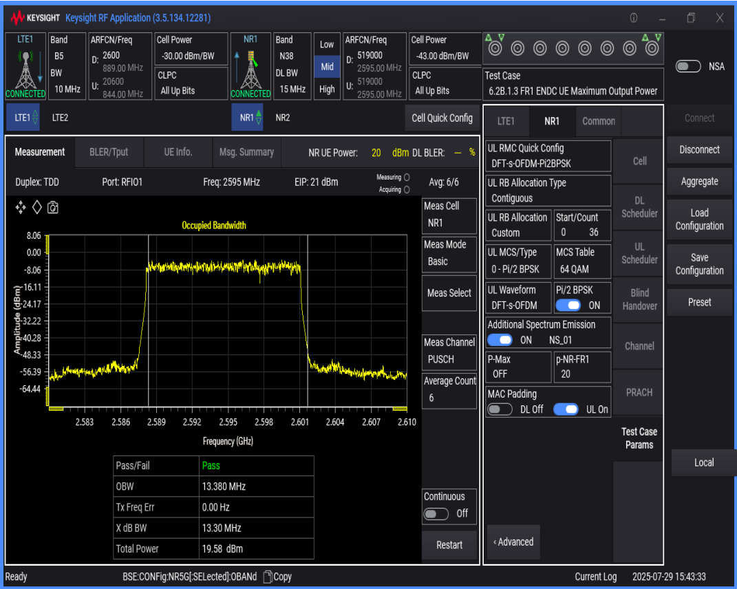
n38 SCS=30kHz DFT_BPSK BW=10MHz Channel=519000 RB=24@0
