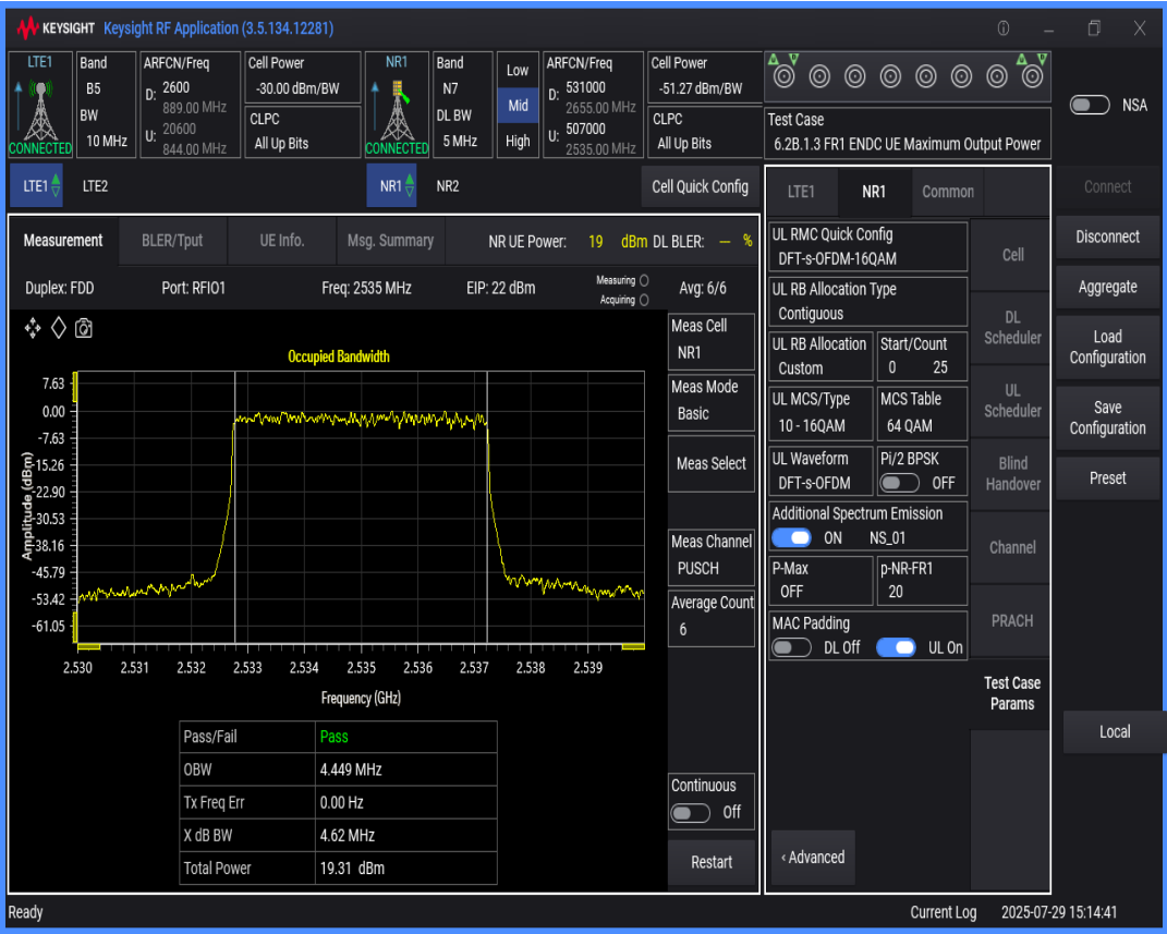
n7 SCS=15kHz DFT_QAM256 BW=10MHz Channel=507000 RB=50@0
