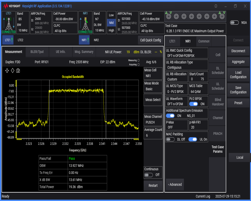
n7 SCS=15kHz DFT_BPSK BW=20MHz Channel=507000 RB=100@0
