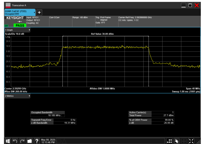
n41_30MHz_30kHz_2592.99MHz_DFT-s-OFDM \pi/2 BPSK_RB75@0
