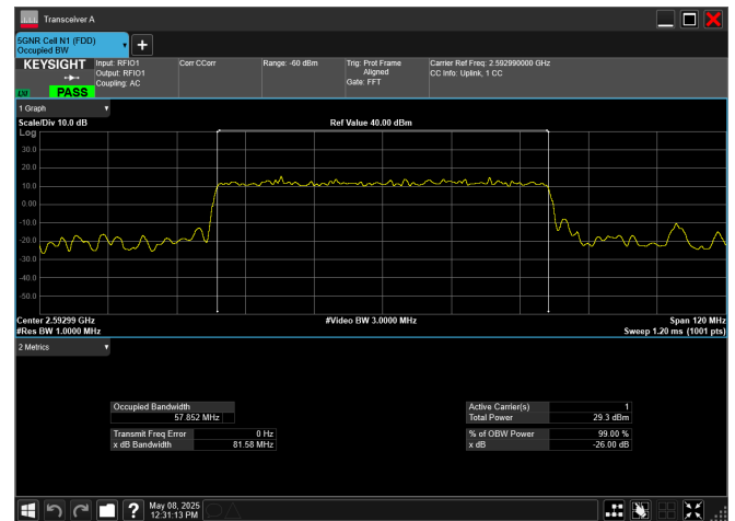
n41_80MHz_30kHz_2592.99MHz_DFT-s-OFDM \pi/2 BPSK_RB216@0
