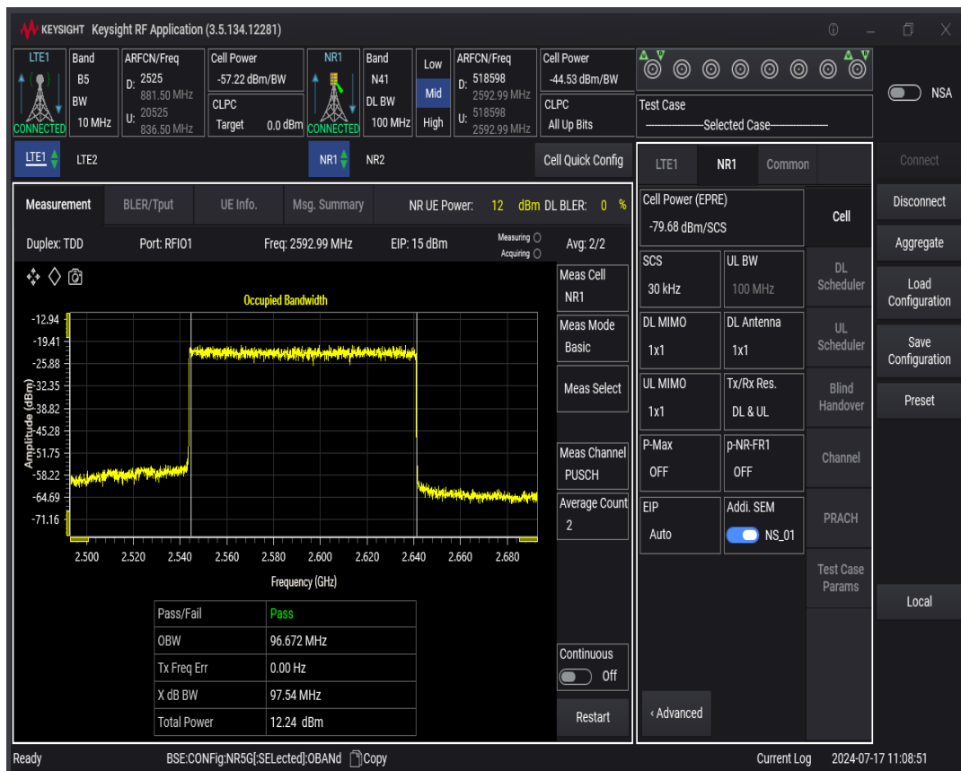
n41 SCS=30kHz DFT_QAM64 BW=20MHz Channel=518598 RB=50@0
