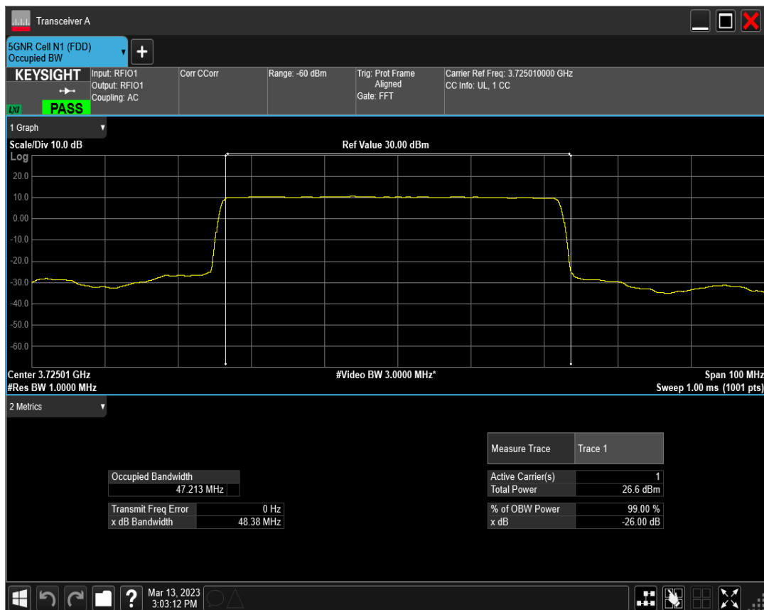
n77(3700-3980) SCS=30kHz DFT_QPSK BW=50MHz Channel=648334 RB=128@0
