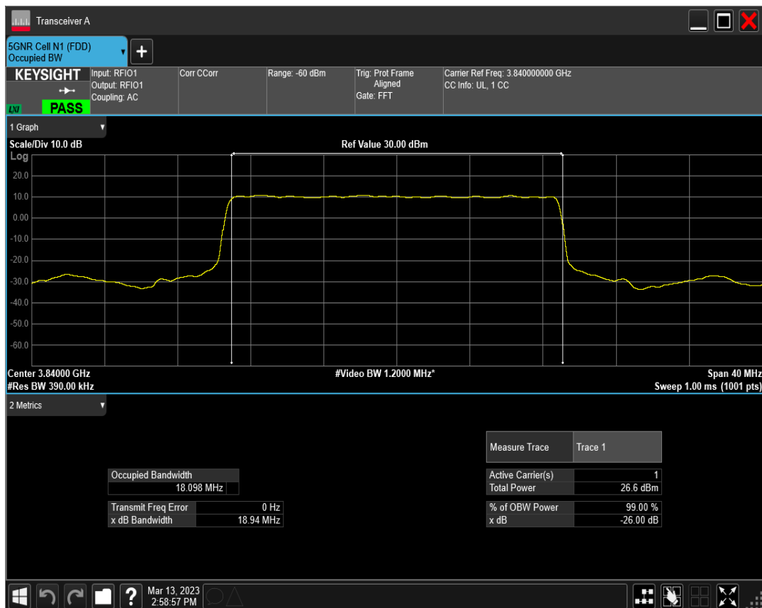
n77(3700-3980) SCS=30kHz DFT_QPSK BW=20MHz Channel=656000 RB=50@0
