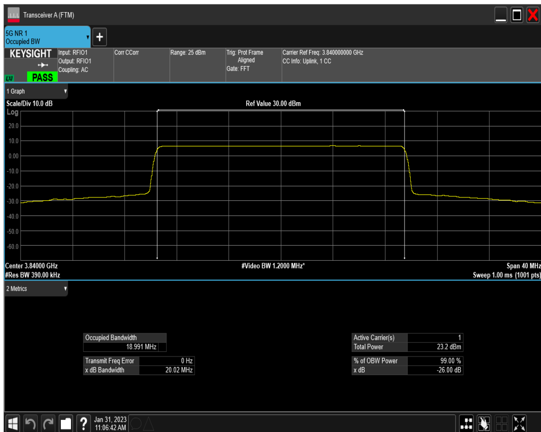
n77(3700-3980) SCS=15kHz DFT_BPSK BW=20MHz Channel=664666 RB=100@0
