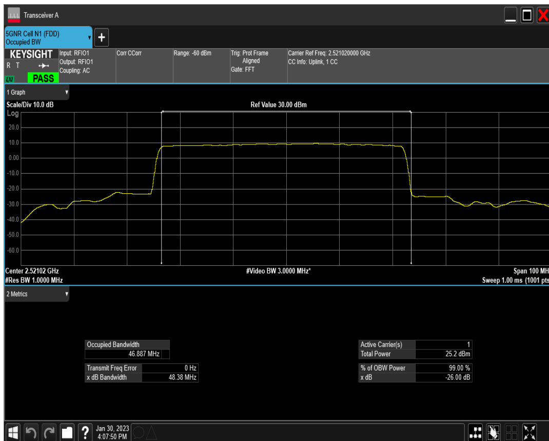
n41 SCS=30kHz DFT_QPSK BW=50MHz Channel=504204 RB=128@0
