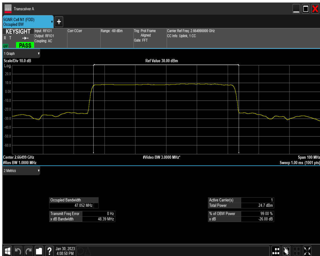
n41 SCS=30kHz DFT_QPSK BW=50MHz Channel=532998 RB=128@0
