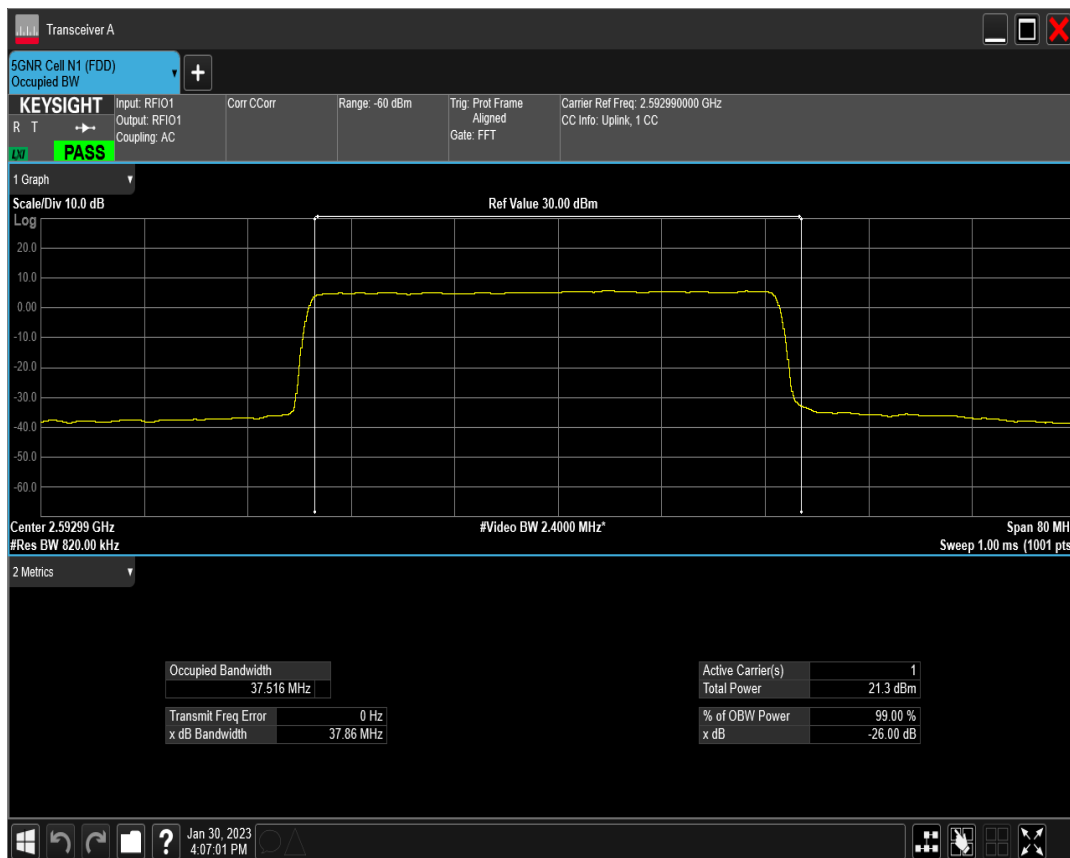
n41 SCS=30kHz CP_QPSK BW=40MHz Channel=518598 RB=106@0
