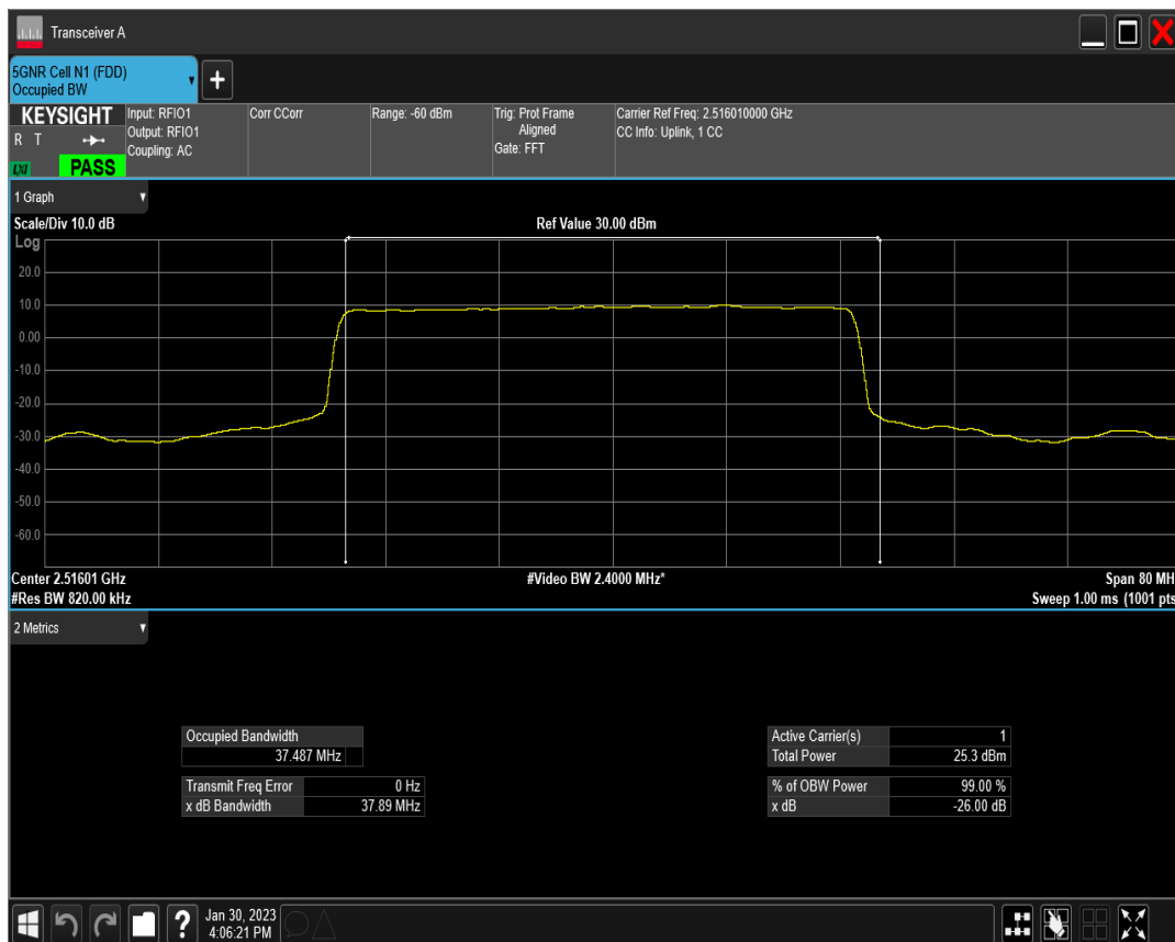
n41 SCS=30kHz DFT_QPSK BW=40MHz Channel=503202 RB=100@0
