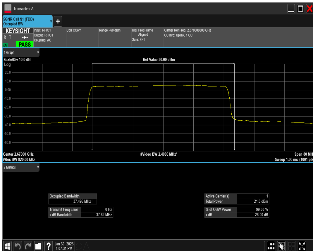
n41 SCS=30kHz CP_QPSK BW=40MHz Channel=534000 RB=106@0
