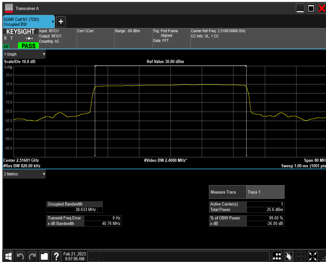
n41 SCS=15kHz DFT_QPSK BW=40MHz Channel=503202 RB=216@0
