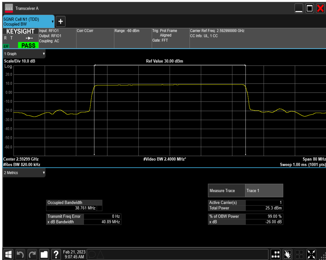
n41 SCS=15kHz DFT_QPSK BW=40MHz Channel=518598 RB=216@0
