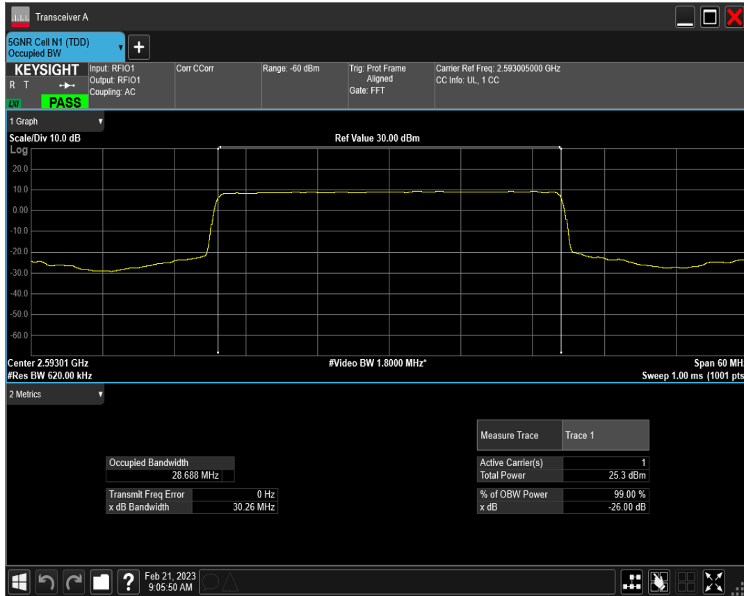
n41 SCS=15kHz DFT_QPSK BW=30MHz Channel=518601 RB=160@0
