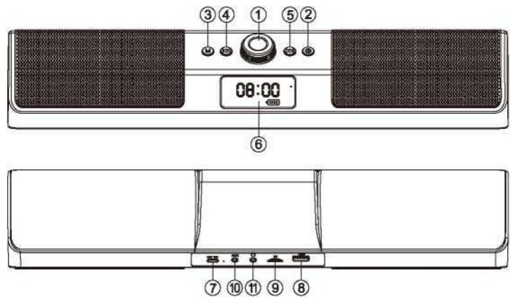
1. 编码器音量旋钮:逆时针旋转为音量变小,顺时针旋钮为音量增加。
