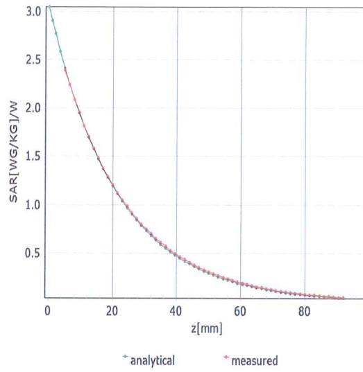
$f=1750 \text{ MHz}, \text{WGLS R22}(H_{\text{convF}})$
