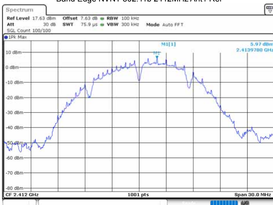
Band Edge NVNT 802.11b 2412MHz Ant1 Ref
