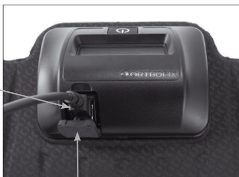
Cubierta del puerto de carga
