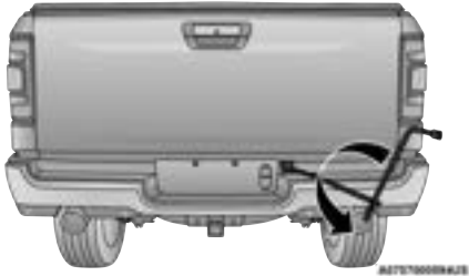
Rotating The Lug Wrench Handle
