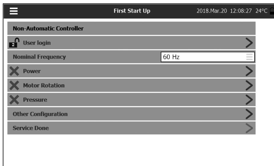
Une fois que le contrôleur a démarré, la page "Premier démarrage" s'affiche. Le contrôleur détectera et affichera automatiquement la fréquence de la source d'alimentation. Il est alors possible de choisir manuellement la fréquence de la tension.
