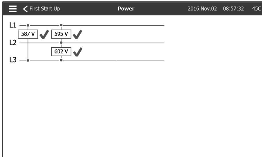
Vérifiez que la tension normale affichée sur L1-L2, L2-L3 et L1-L3 est la même que celle indiquée sur la plaque signalétique des contrôleurs de pompe à incendie. Le contrôleur de la pompe à incendie valide automatiquement la tension nominale par rapport à ce qui a été construit.
