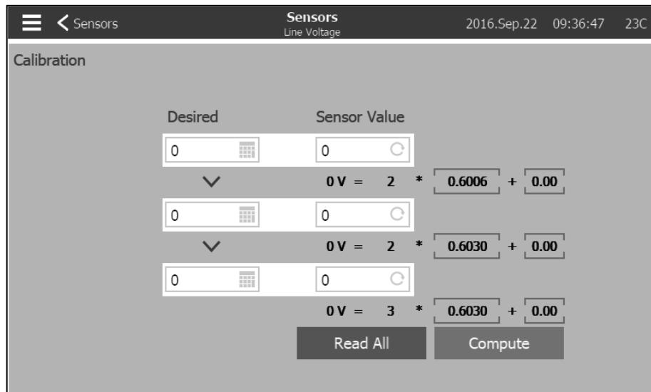
Pour calibrer le capteur de tension de ligne, utilisez un voltmètre externe déjà calibré. Avec le panneau de commande sous tension:
