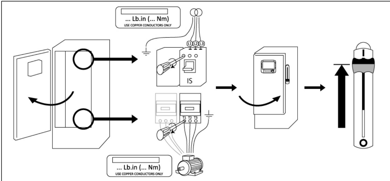
Brancher l'alimentation d'entrée et le moteur sur leurs bornes respectives. Sécuriser comme indiqué sur l'étiquette avec le couple de serrage approprié et vérifier tous les branchements. Sécuriser la porte en position fermée, placer en position ON les manivelles de déconnexion des disjoncteurs. Vérifier les explications sur l'écran principal du contrôleur.
