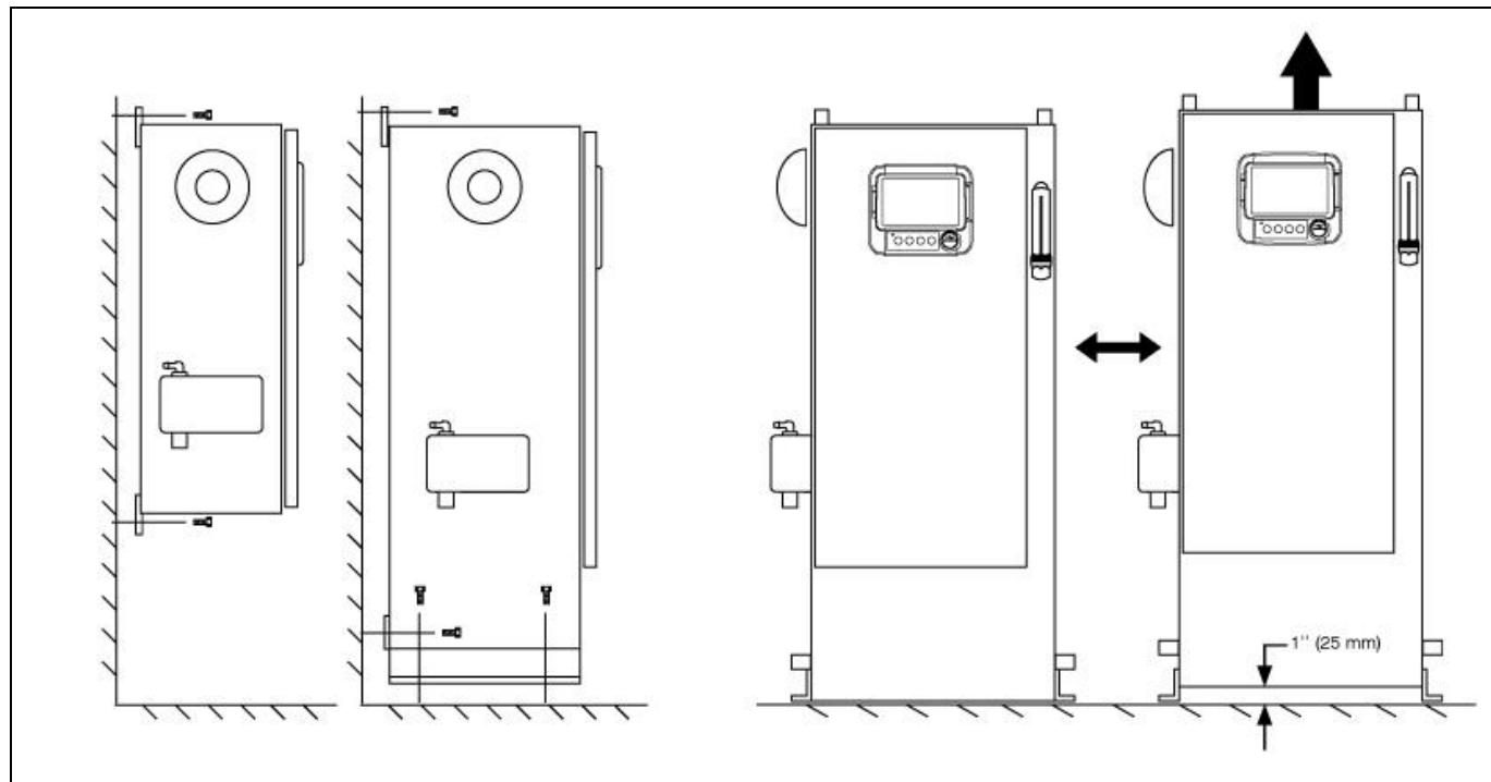
Vérifiez que le contrôleur est installé en toute sécurité sur le mur ou en option sur le support de montage.
