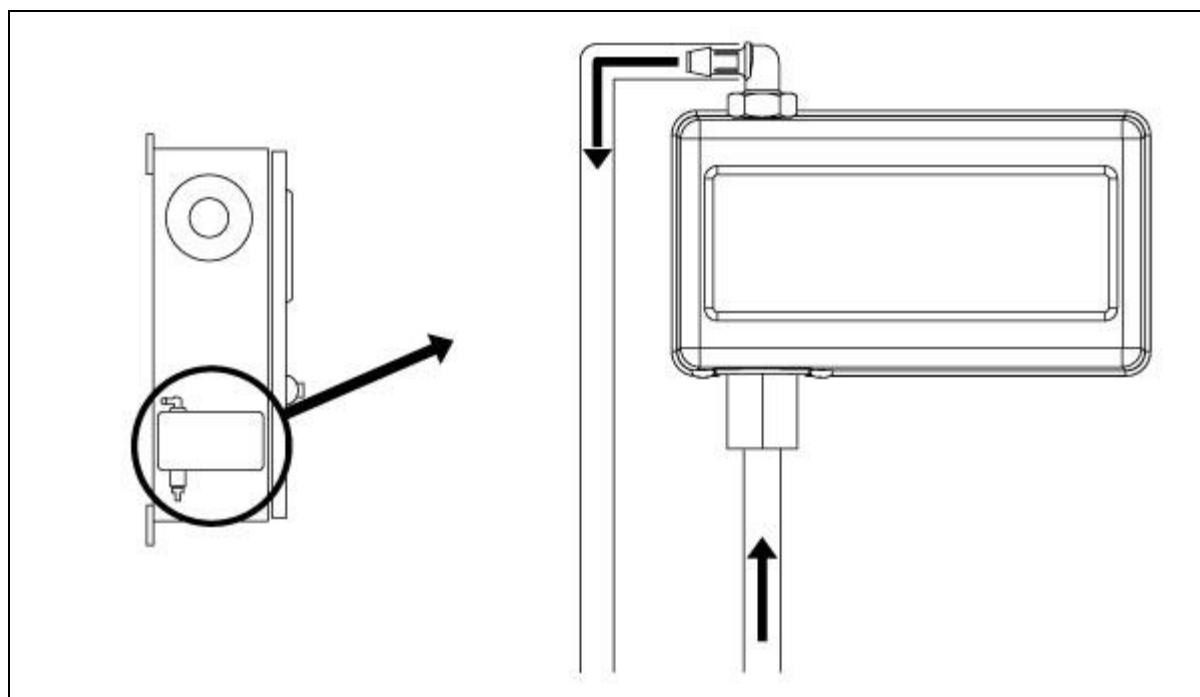
Vérifier et/ou installer les raccordements appropriés pour l'arrivée d'eau et le tuyau d'écoulement. Il faut les installer et les serrer solidement. Se reporter aux marquages par sérigraphie sur la couvercle en plastique.
