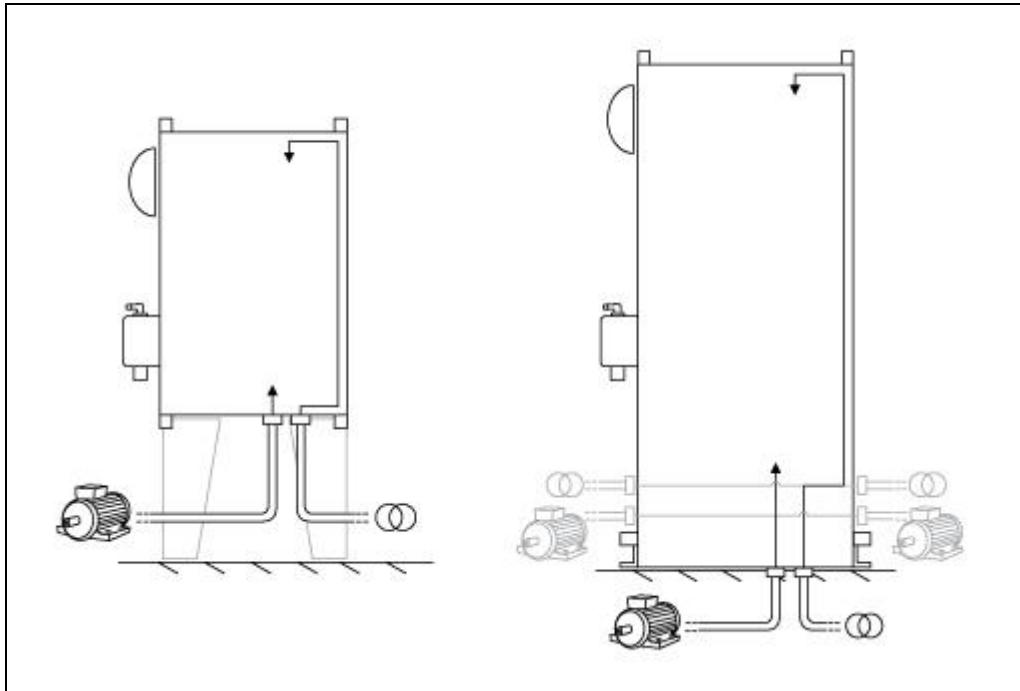
Percer des trous pour les connexions du moteur et pour l'alimentation électrique. Faire passer les câbles à l'intérieur du panneau en conformité avec les spécifications afin de minimiser les interférences avec d'autres équipements.
