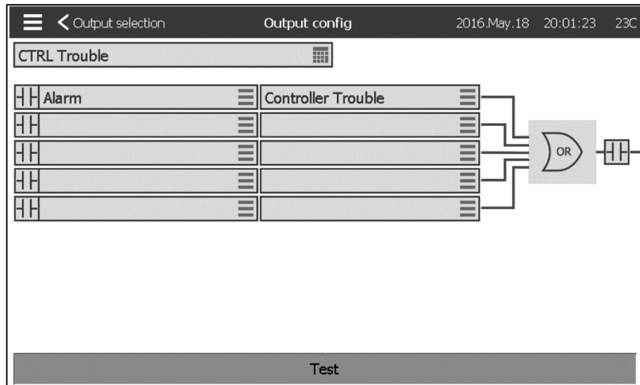
La première case à partir du haut permet de changer le nom de la sortie. Pour la logique de sortie, une combinaison de 5 entrées numériques peut être sélectionnée. Chaque entrée peut être une alarme ou un signal d'une liste et peut être inversée en appuyant sur le symbole de contact NO / NC à gauche de l'écran. Une logique AND ou OR peut combiner les entrées choisies et la sortie peut également être inversée en appuyant sur le symbole de contact NO / NC à droite de l'écran.
