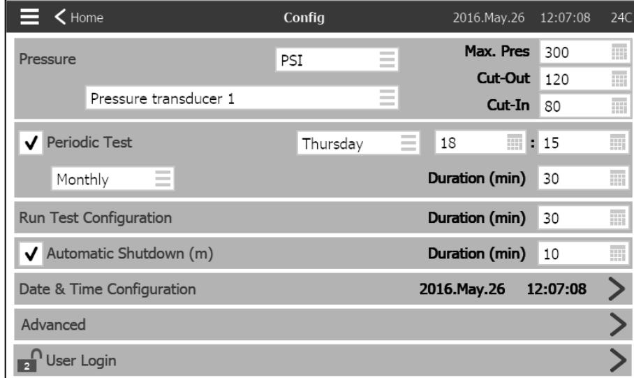
La page de configuration principale est utilisée pour configurer tous les paramètres de configuration de base et fournit un moyen rapide de modifier les paramètres les plus courants.
