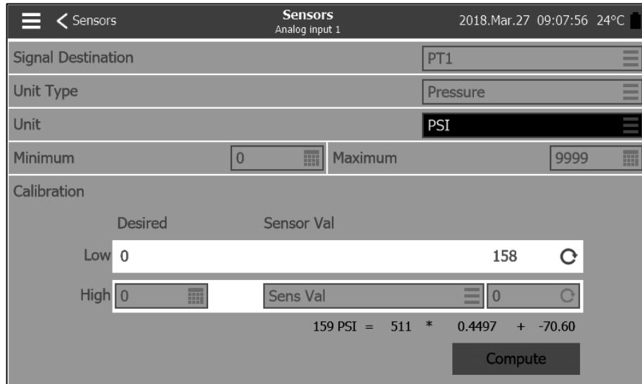
Pour le transducteur de pression PT1, le point bas (zéro) est automatiquement acquis lors de la première mise sous tension. Il peut être acquis de nouveau en appuyant sur la flèche ronde bleue. Le point haut doit être entré pour calibrer le capteur.
