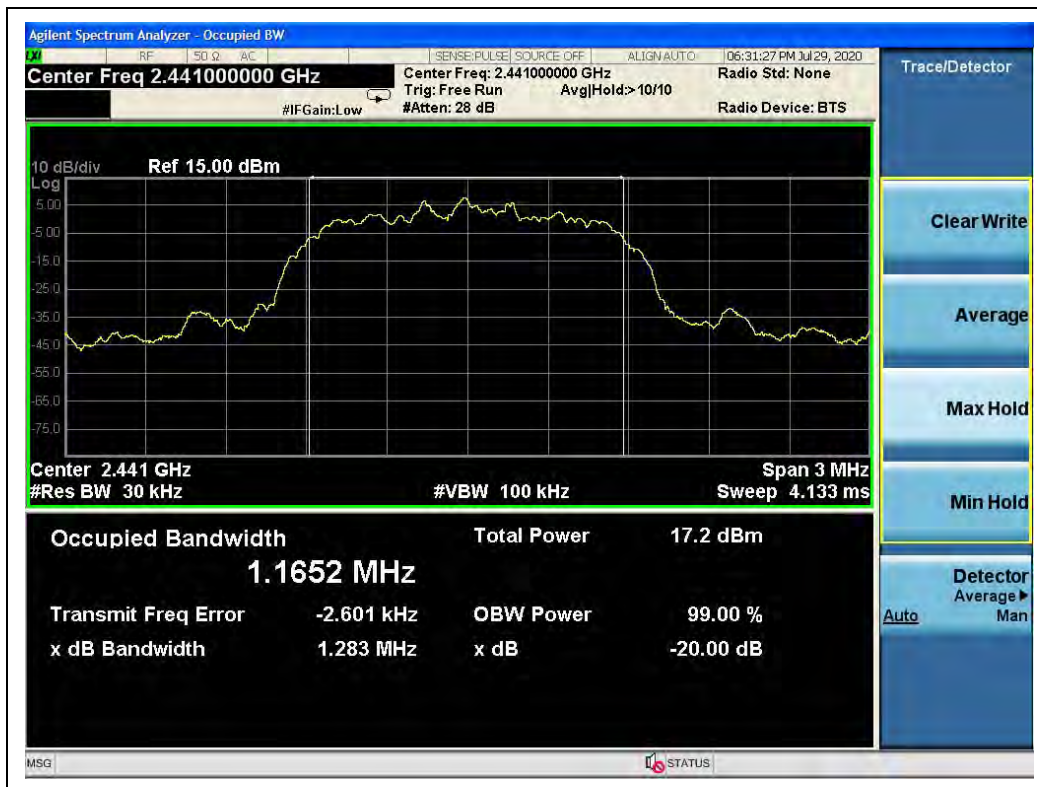
(Channel 39, \pi/4 -DQPSK)
