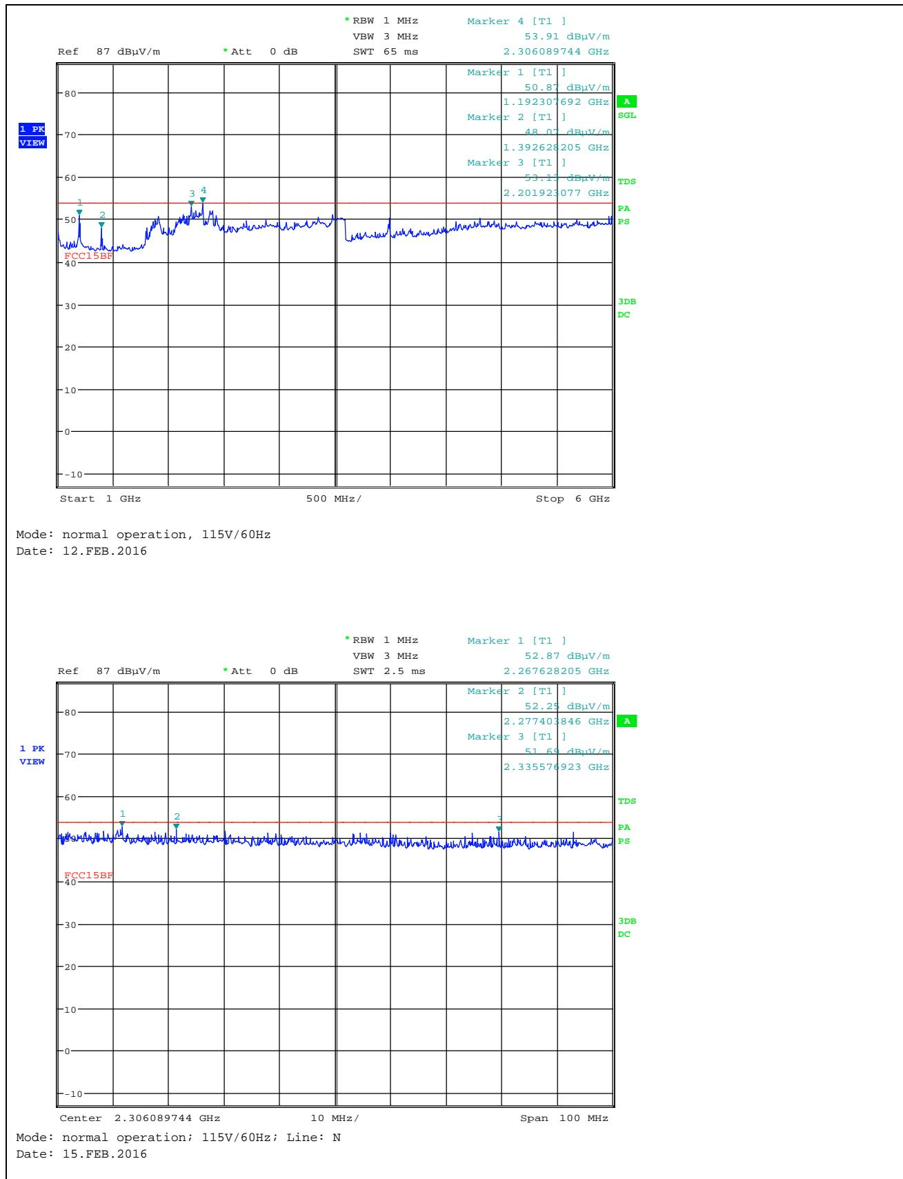
Test of Carstens Medizinelektronik GmbH AG501 to 47 CFR §§ 15.207, 15.209
