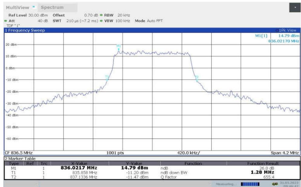
**LTE band 26 (824 MHz-849 MHz),3MHz(-26dBc)**
