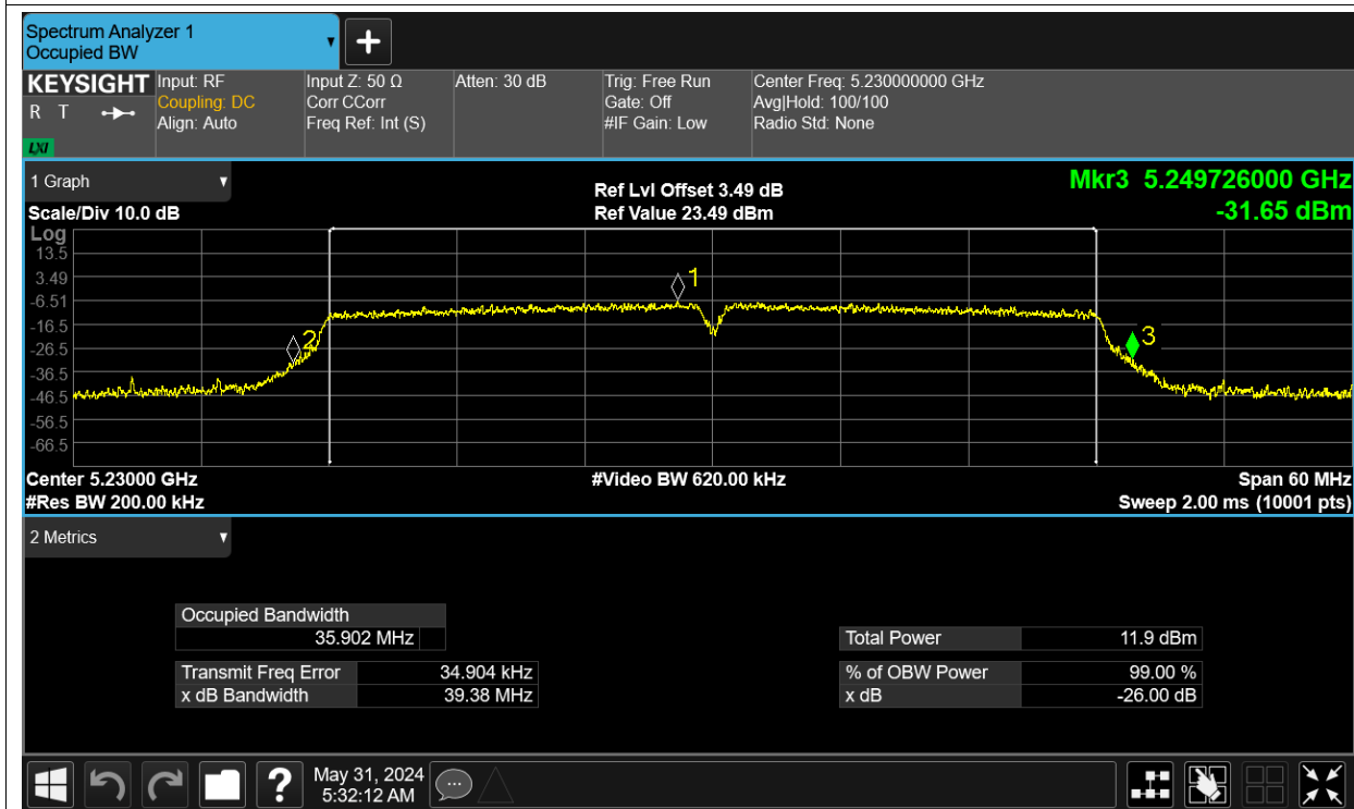
-26dB Bandwidth NVNT ac80 5210MHz Ant1
