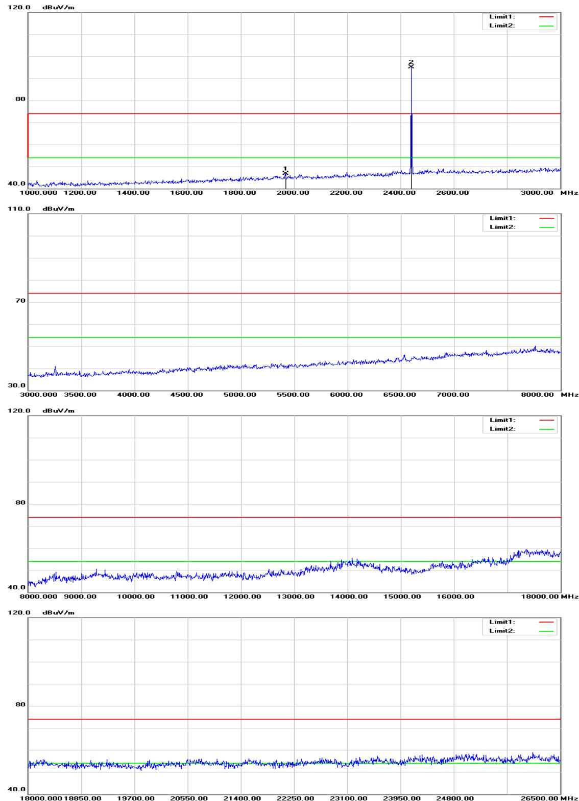
**Operation Mode:** TX / GFSK / DH5 / CH Mid
