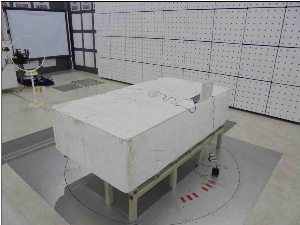
RADIATED EMISSION TEST- Mode B
