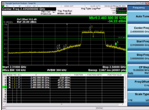
,Plot 2,Band Edge-802.11n(HT40) ,2452MHz,Ant0
