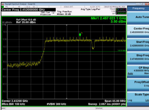
,Plot 1,Reference Level-802.11n(HT40) ,2452MHz,Ant0
