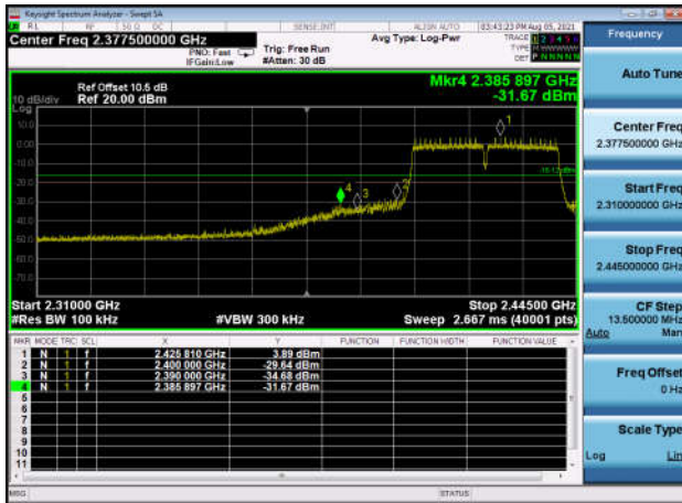
,Plot 2,Band Edge-802.11n(HT40) ,2437MHz,Ant0
