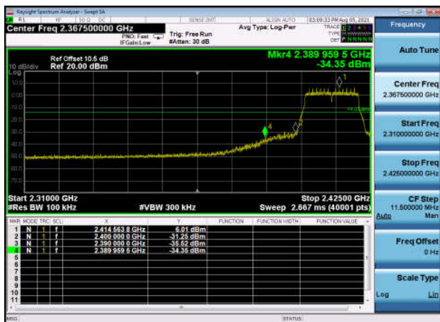
,Plot 2,Band Edge-802.11n(HT20) ,2437MHz,Ant0
