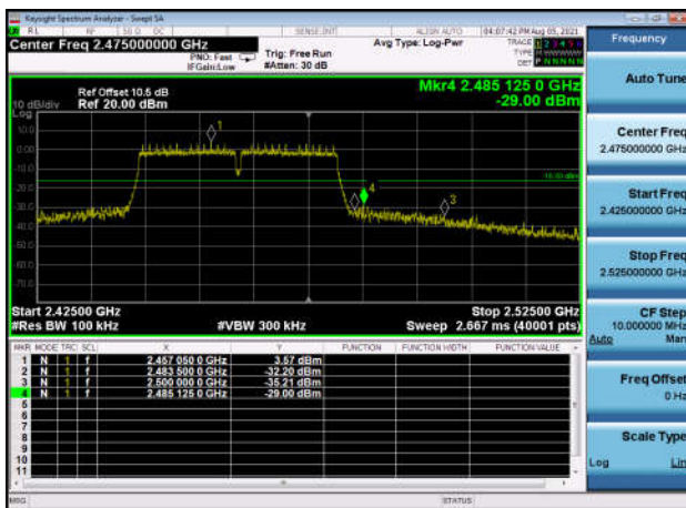
,Plot 2,Band Edge-802.11n(HT40) ,2452MHz,Ant0
