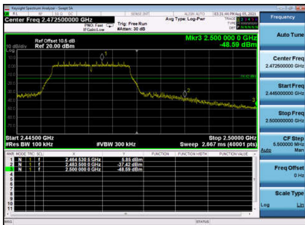
,Plot 2,Band Edge-802.11n(HT20) ,2462MHz,Ant0
