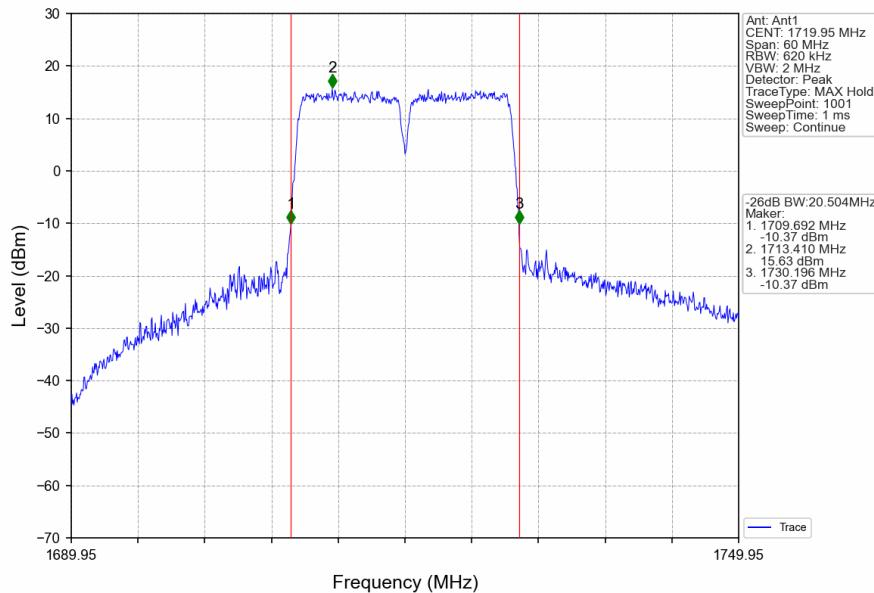
CA\_66B\_SISO\_NTNV\_CC1:10 CC2:10MHz\_CC1:16QAM CC2:16QAM\_CC1:1765.1 CC2:1775MHz\_CC1: 50@0 CC2: 50@0
