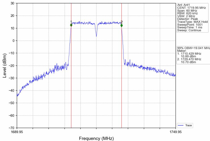
CA\_66B\_SISO\_NTNV\_CC1:10 CC2:10MHz\_CC1:16QAM CC2:16QAM\_CC1:1765.1 CC2:1775MHz\_CC1: 50@0 CC2: 50@0
