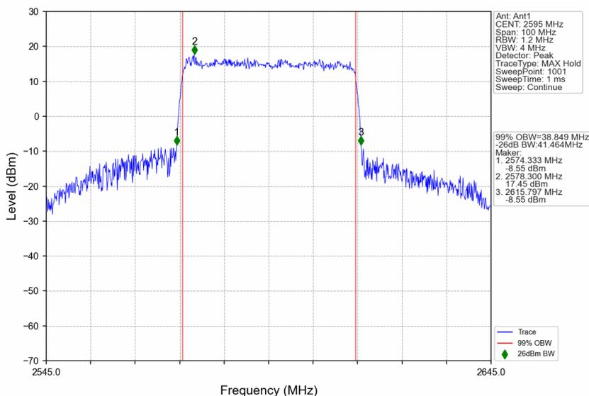
n38\_15kHz\_SISO\_NTNV\_40MHz\_CP-OFDM 64 QAM\_2600MHz\_Outer\_Full
