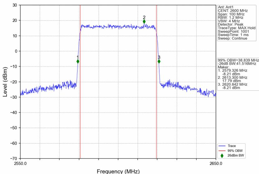
n38\_15kHz\_SISO\_NTNV\_40MHz\_DFT-s-OFDM 64 QAM\_2590MHz\_Outer\_Full
