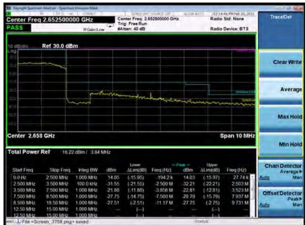
LTE Band 41 64QAM 10MHz CH-Low, 1 RB
