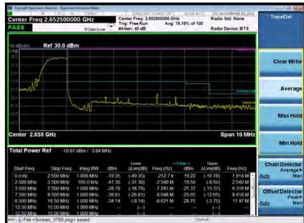
LTE Band 41 16QAM 5MHz CH-Low, 100%RB
