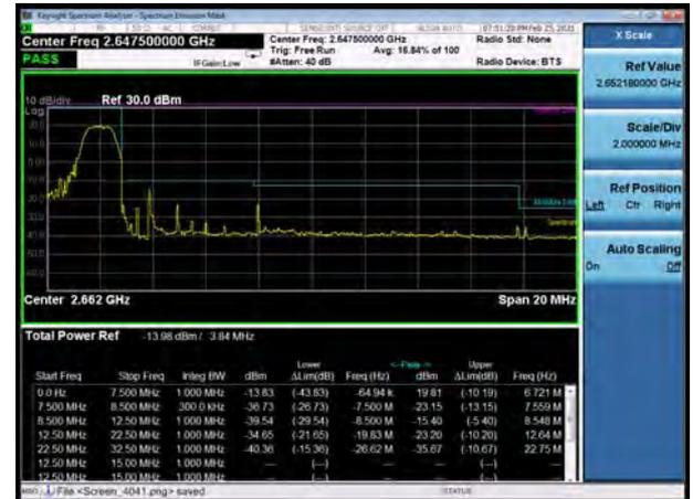
LTE Band 41 16QAM 15MHz CH-Low, 100%RB
