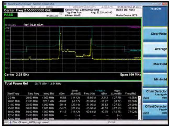
CA\_7C 16QAM 20MHz+20MHz CH-Low, 1 RB
