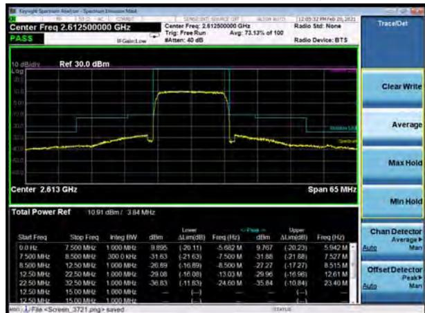
LTE Band 38 64QAM 20MHz CH-Low, 1 RB
