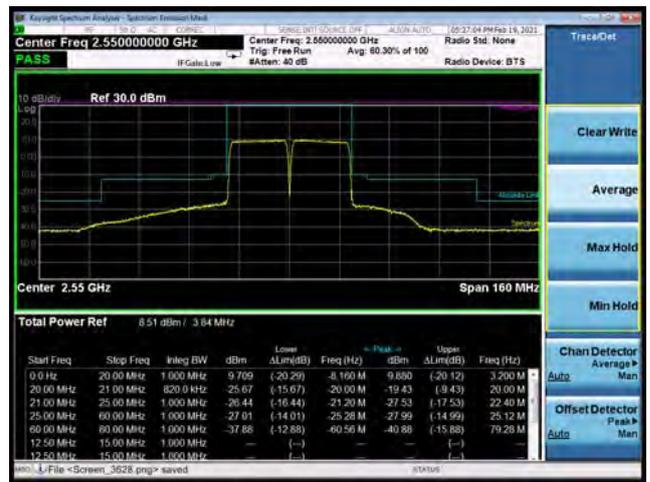
CA\_7C 16QAM 20MHz+20MHz CH-Low, 100%RB
