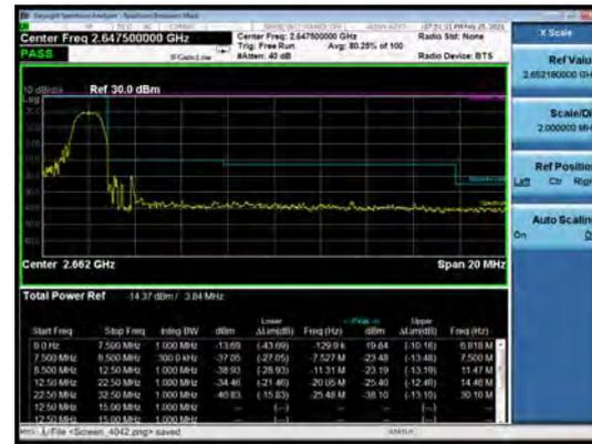
LTE Band 41 64QAM 15MHz CH-Low, 100%RB
