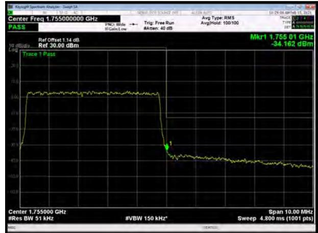
LTE Band 4 64QAM 10MHz CH-Low, 1 RB
