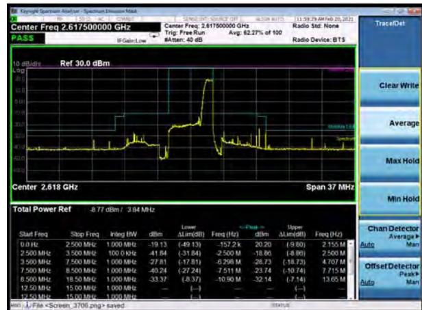
LTE Band 38 16QAM 5MHz CH-Low, 100%RB
