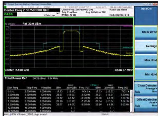
LTE Band 7 64QAM 10MHz CH-Low, 1 RB
