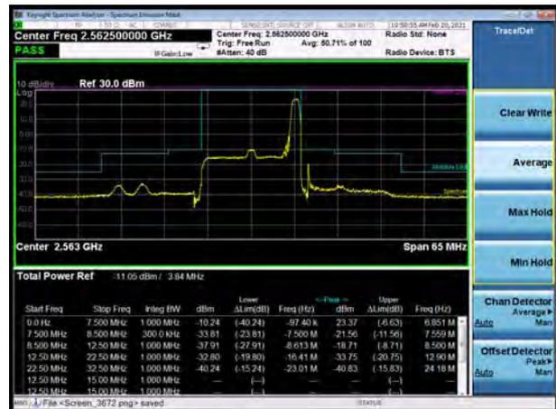
LTE Band 7 64QAM 15MHz CH-Low, 100%RB
