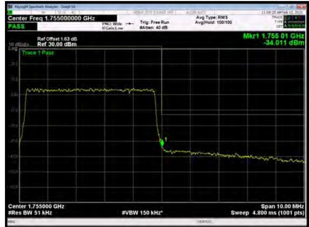
LTE Band 4 16QAM 10MHz CH-Low, 1 RB
