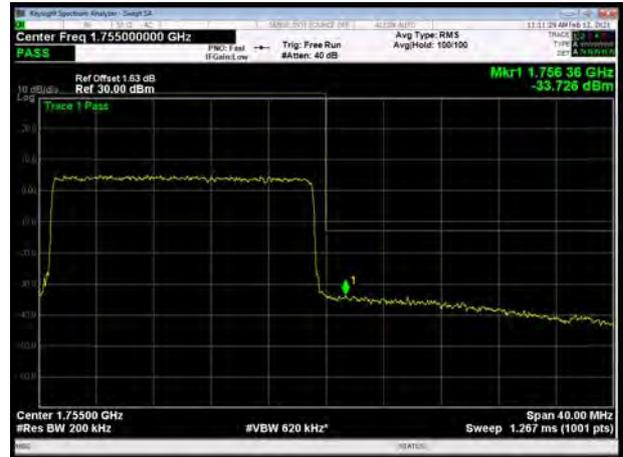
LTE Band 4 16QAM 1.4MHz CH-Low, 1 RB
