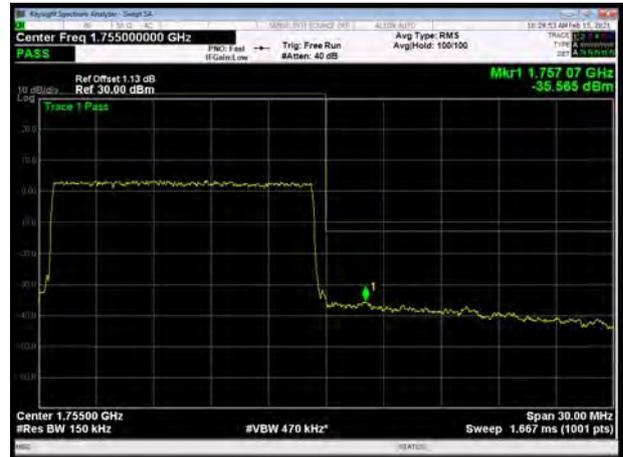
LTE Band 4 64QAM 20MHz CH-Low, 1 RB
