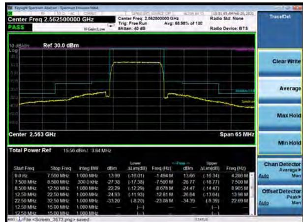
LTE Band 7 64QAM 20MHz CH-Low, 1 RB
