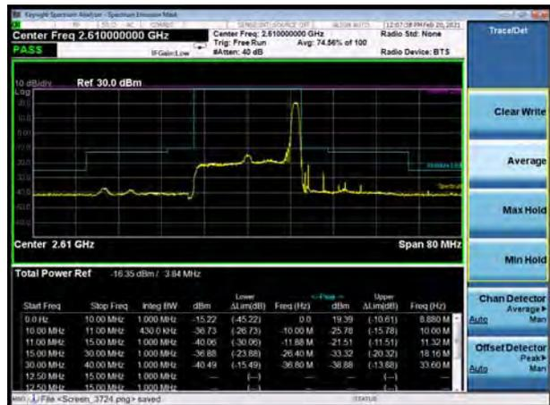
LTE Band 38 16QAM 20MHz CH-Low, 100%RB
