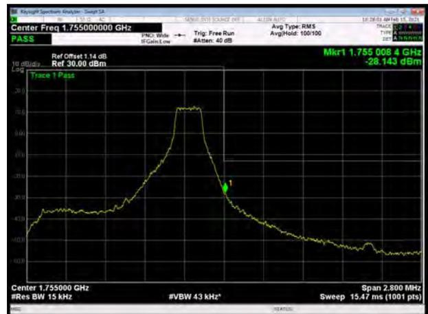
LTE Band 4 64QAM 1.4MHz CH-Low, 100%RB
