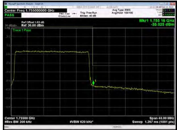
LTE Band 4 64QAM 1.4MHz CH-Low, 1 RB
