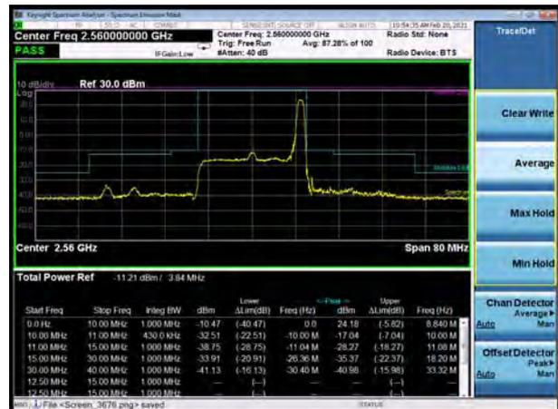
LTE Band 7 16QAM 20MHz CH-Low, 100%RB
