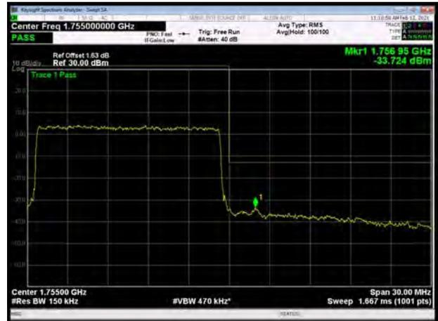
LTE Band 4 16QAM 20MHz CH-Low, 1 RB
