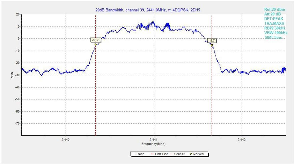
Fig.101. 20dB Bandwidth:  $\pi/4$  DQPSK, Channel 39
