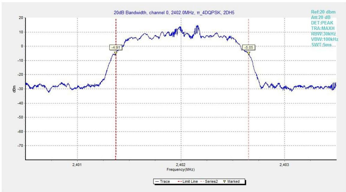
Fig.100. 20dB Bandwidth:  $\pi/4$  DQPSK, Channel 0
