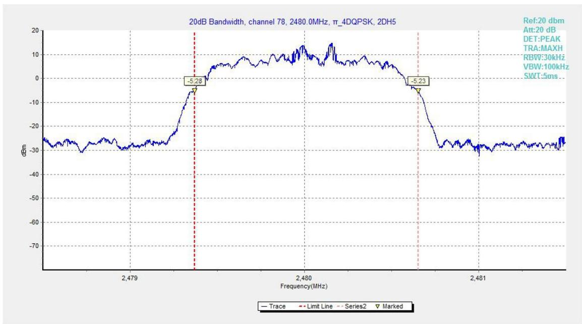
Fig.102. 20dB Bandwidth:  $\pi/4$  DQPSK, Channel 78
