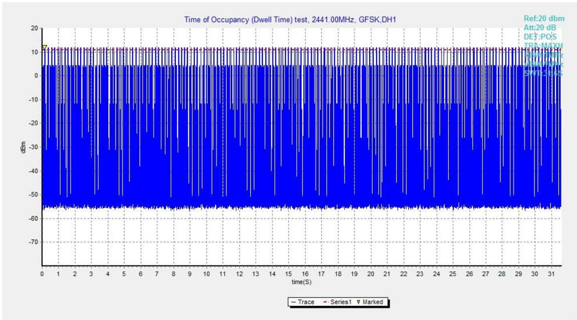
Fig.80. Number of Transmissions Measurement: Channel 39,Packet DH1
