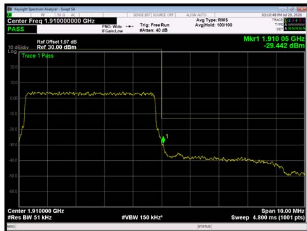
LTE Band 2 10MHz QPSK 1RB CH-High
