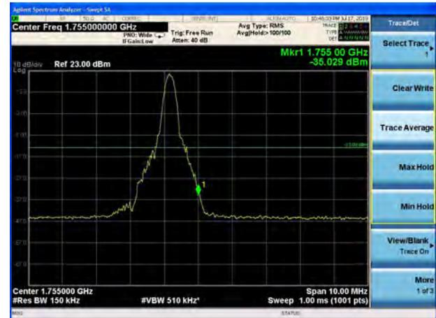
LTE Band 4 16QAM 15MHz CH-Low, 100%RB
