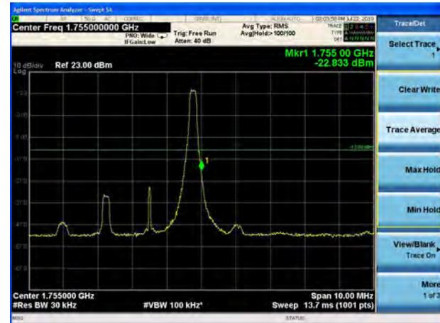
LTE Band 4 64QAM 3MHz CH-Low, 100%RB
