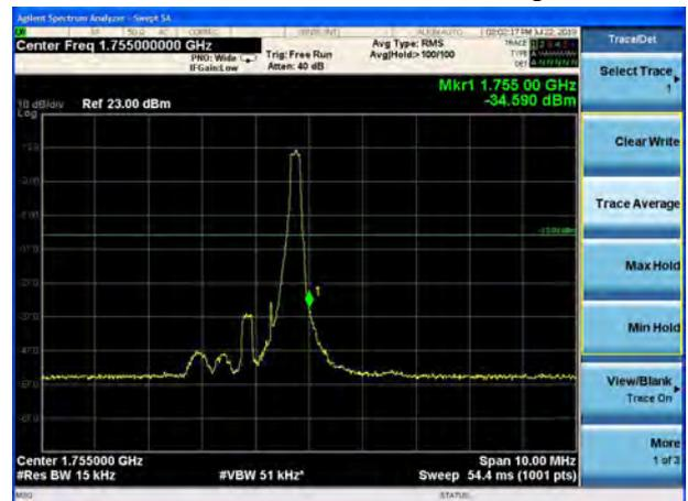
LTE Band 4 64QAM 1.4MHz CH-Low, 100%RB
