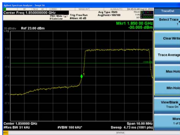
LTE Band 2 10MHz QPSK 1RB CH-Low
