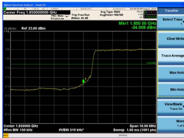
LTE Band 2 20MHz QPSK 1RB CH-Low
