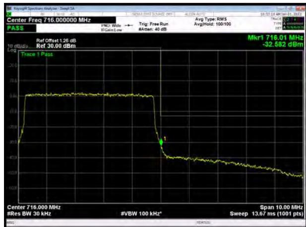
LTE Band 12 16QAM 10MHz CH-Low, 1 RB
