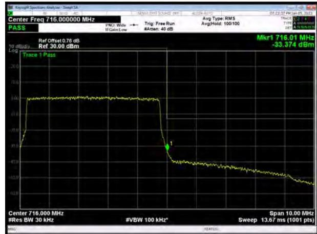
LTE Band 12 64QAM 10MHz CH-Low, 1 RB
