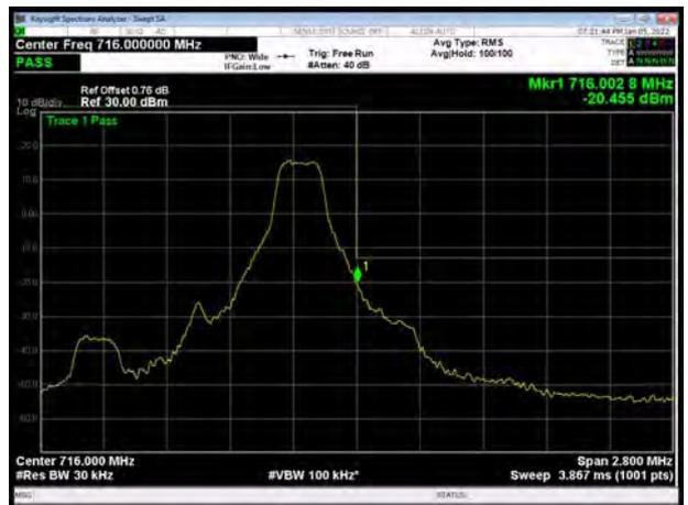
LTE Band 12 64QAM 1.4MHz CH-Low, 100%RB
