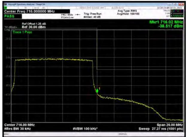
LTE Band 12 64QAM 1.4MHz CH-Low, 1 RB
