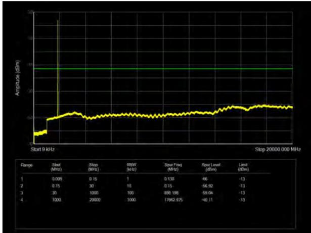
LTE Band 2 10MHz CH-Low 9kHz~20GHz
