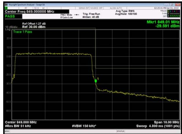
LTE Band 5 16QAM 10MHz CH-Low 1RB
