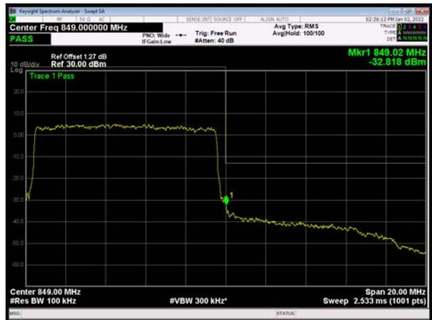
LTE Band 5 16QAM 1.4MHz CH-Low 1RB
