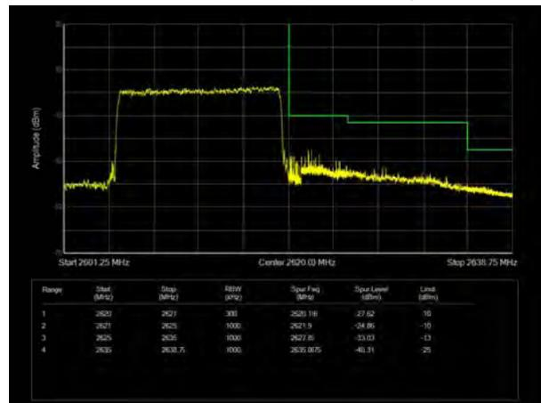
LTE Band 38 16QAM 20MHz CH-Low, 1 RB
