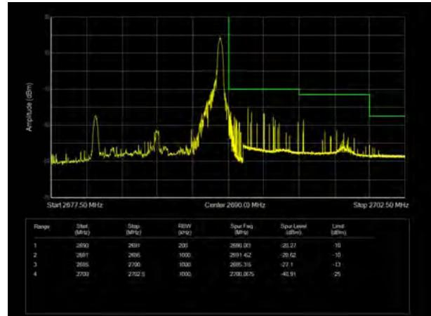
LTE Band 41 16QAM 10MHz CH-Low, 100%RB
