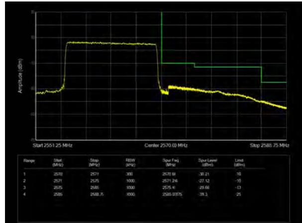
LTE Band 7 16QAM 20MHz CH-Low, 1 RB
