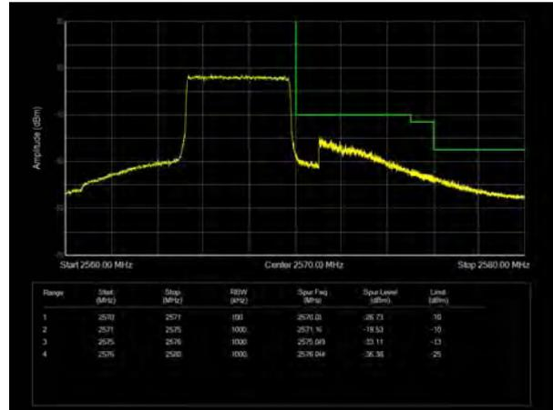
LTE Band 7 16QAM 10MHz CH-Low, 1 RB
