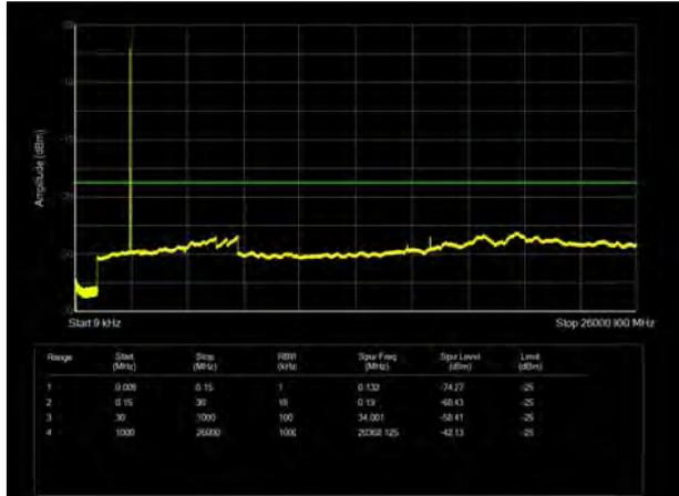
LTE Band 7 20MHz CH-Low 9kHz~26GHz
