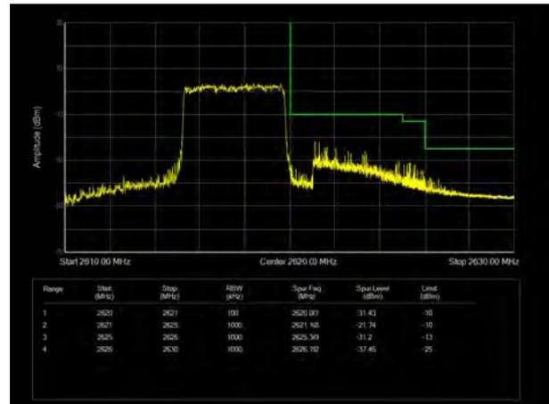
LTE Band 38 16QAM 10MHz CH-Low, 1 RB
