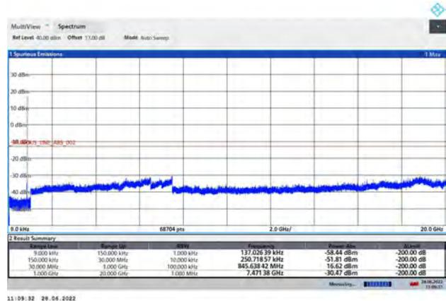
LTE Band 5 1.4MHz CH-Low 9kHz~10GHz
