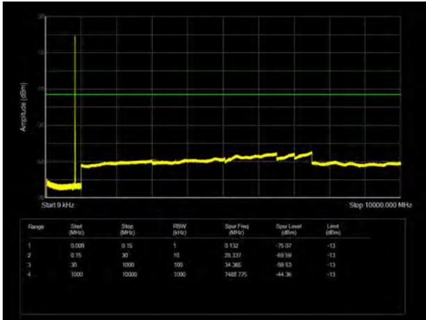
LTE Band 5 10MHz CH-Low 9kHz~10GHz
