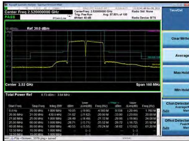
CA\_7C 16QAM 20MHz+20MHz CH-High, 100%RB
