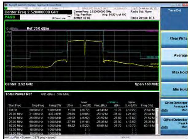
CA\_7C QPSK 20MHz+20MHz CH-High, 100%RB
