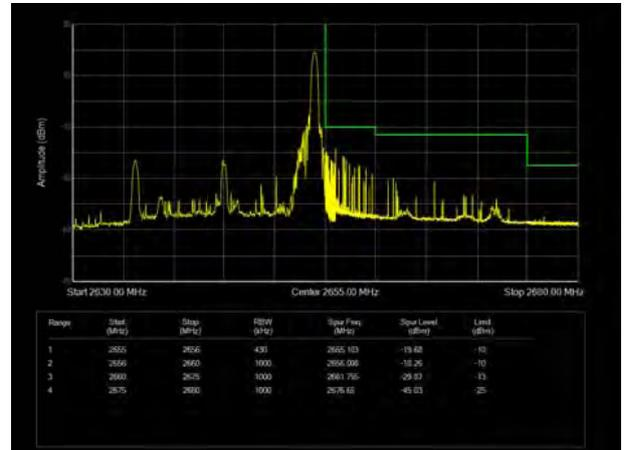
LTE Band 41 64QAM 20MHz CH-Low, 100%RB
