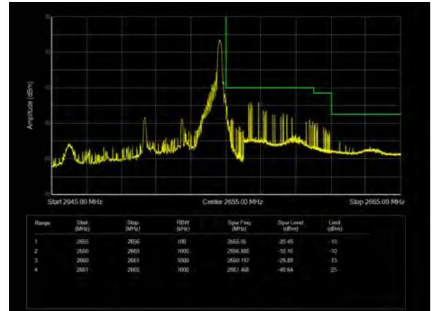
LTE Band 41 64QAM 5MHz CH-Low, 100%RB
