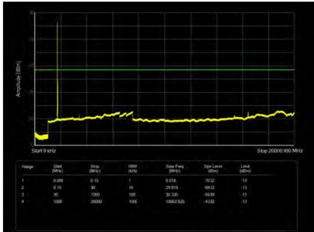
LTE Band 4 20MHz CH-Low 9kHz~20GHz
