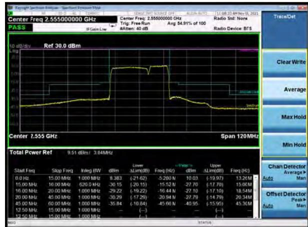
CA\_7C 64QAM 20MHz+10MHz CH-Low, 1 RB
