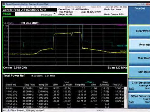
CA\_7C 64QAM 20MHz+10MHz CH-High, 100%RB
