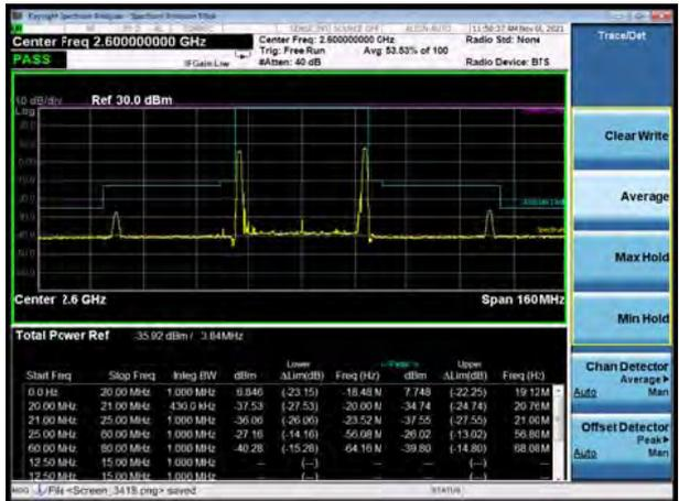
CA\_38C QPSK 20MHz+20MHz CH-Low, 100%RB
