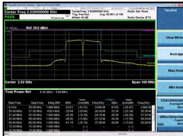
CA\_7C 64QAM 20MHz+20MHz CH-High, 100%RB
