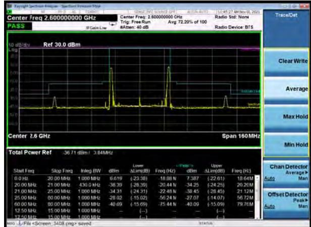
CA\_38C 64QAM 20MHz+20MHz CH-Low, 100%RB
