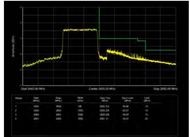
LTE Band 41 64QAM 10MHz CH-Low, 1 RB
