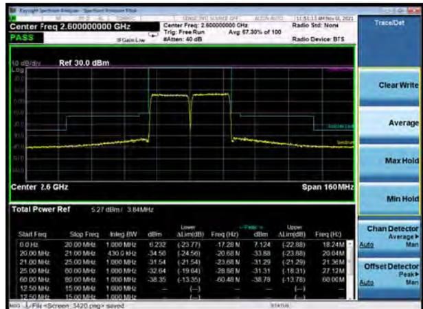
CA\_38C 64QAM 20MHz+20MHz CH-Low, 1 RB
