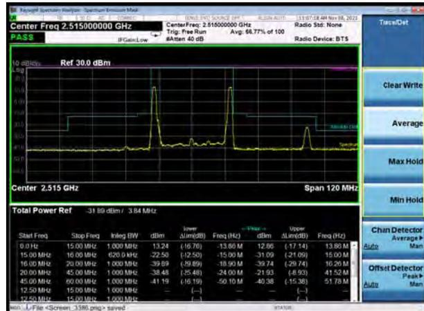
CA\_7C QPSK 20MHz+10MHz CH-Low, 100%RB
