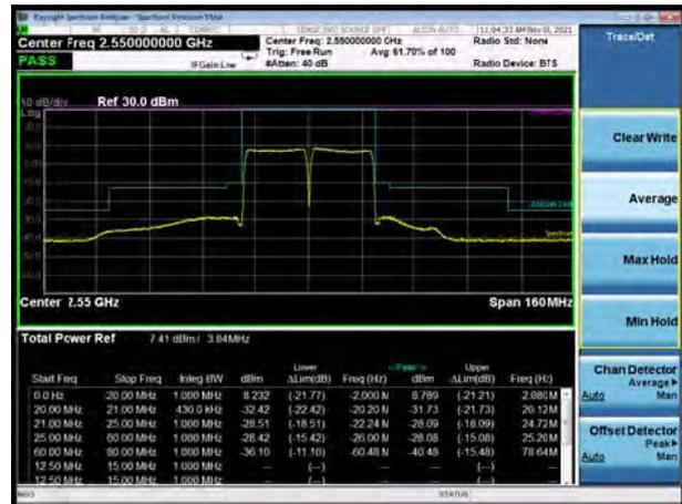
CA\_7C 64QAM 20MHz+20MHz CH-Low, 1 RB
