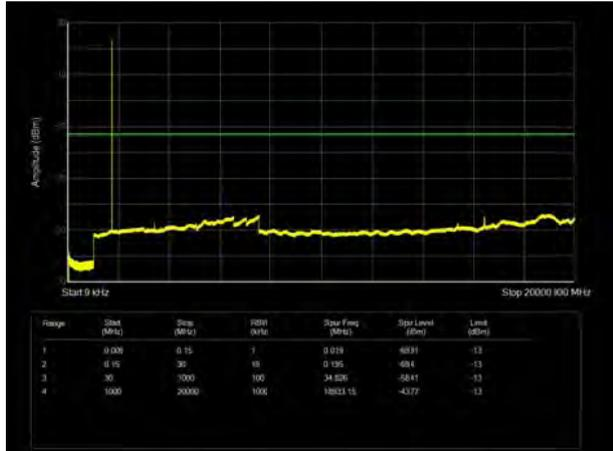
LTE Band 4 3MHz CH- Low 9kHz~20GHz
