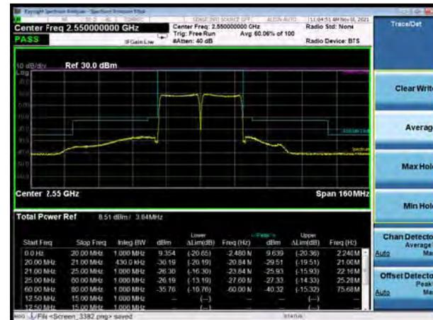
CA\_7C 16QAM 20MHz+20MHz CH-Low, 1 RB
