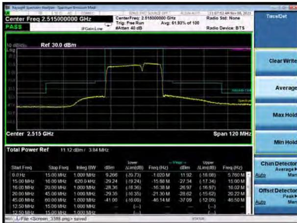
CA\_7C 16QAM 20MHz+10MHz CH-High, 100%RB
