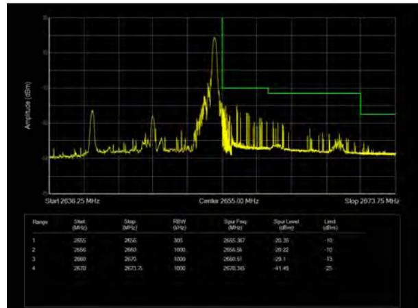
LTE Band 41 64QAM 15MHz CH-Low, 100%RB
