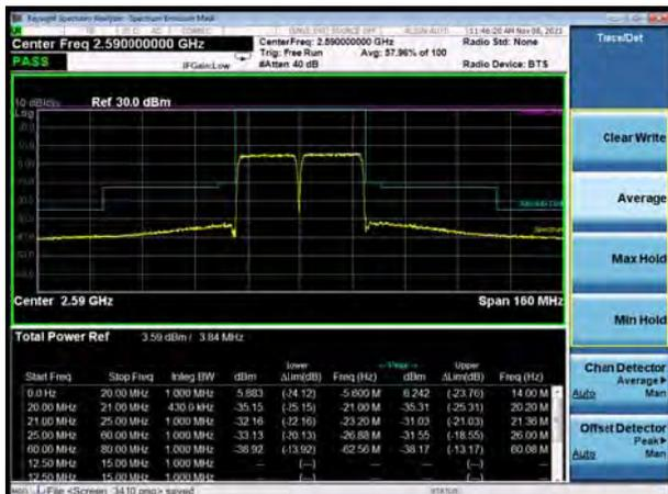
CA\_38C 64QAM 20MHz+20MHz CH-High, 100%RB
