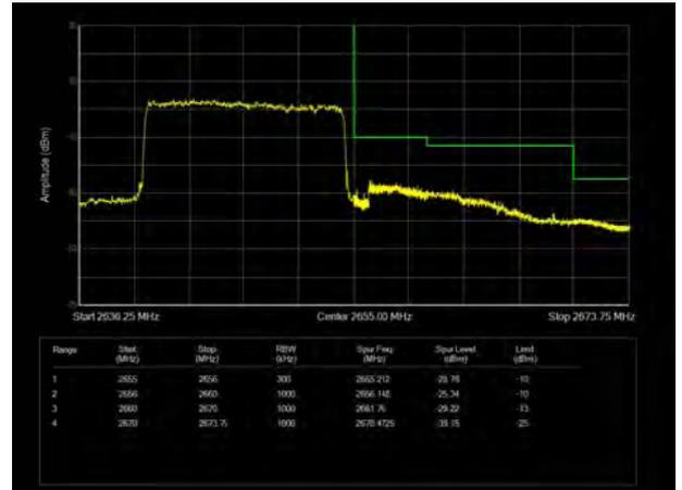
LTE Band 41 64QAM 20MHz CH-Low, 1 RB
