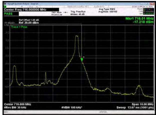
LTE Band 17 16QAM 5MHz CH-Low, 100%RB
