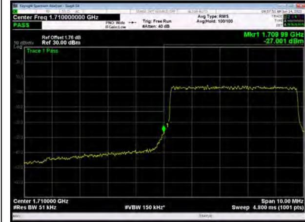
LTE Band 66 16QAM 10MHz CH-Low, 1 RB
