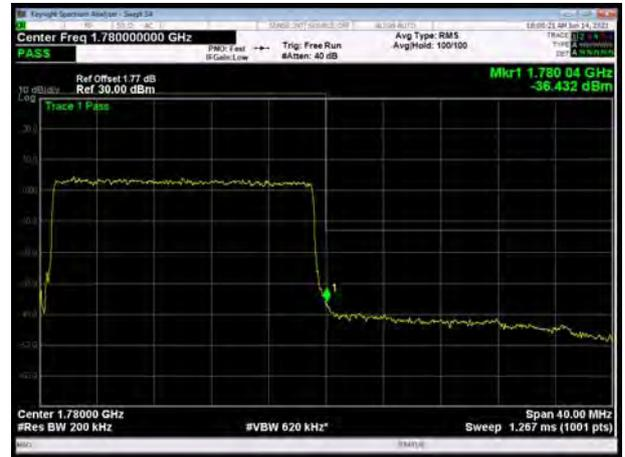
LTE Band 66 64QAM 1.4MHz CH-Low, 1 RB
