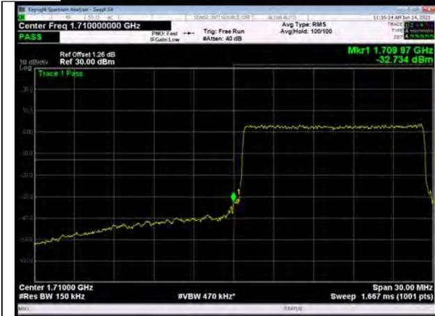
LTE Band 66 64QAM 20MHz CH-Low, 1 RB
