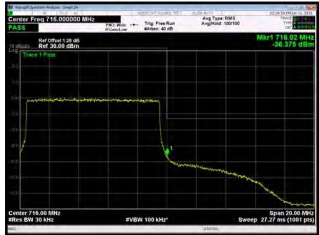
LTE Band 12 16QAM 1.4MHz CH-Low, 1 RB
