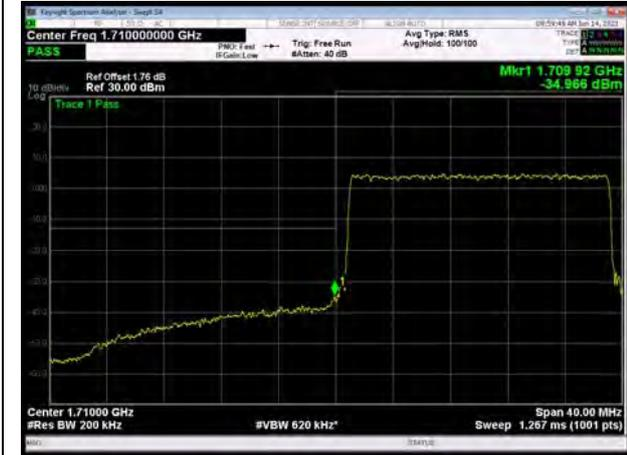
LTE Band 66 16QAM 1.4MHz CH-Low, 1 RB
