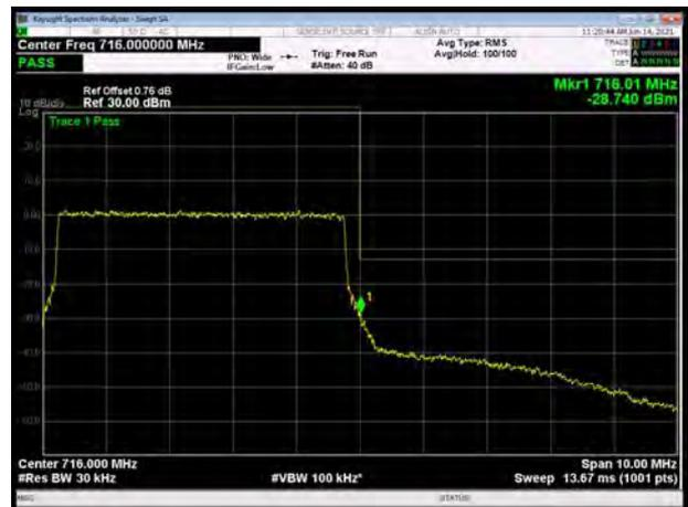
LTE Band 17 64QAM 10MHz CH-Low, 1 RB
