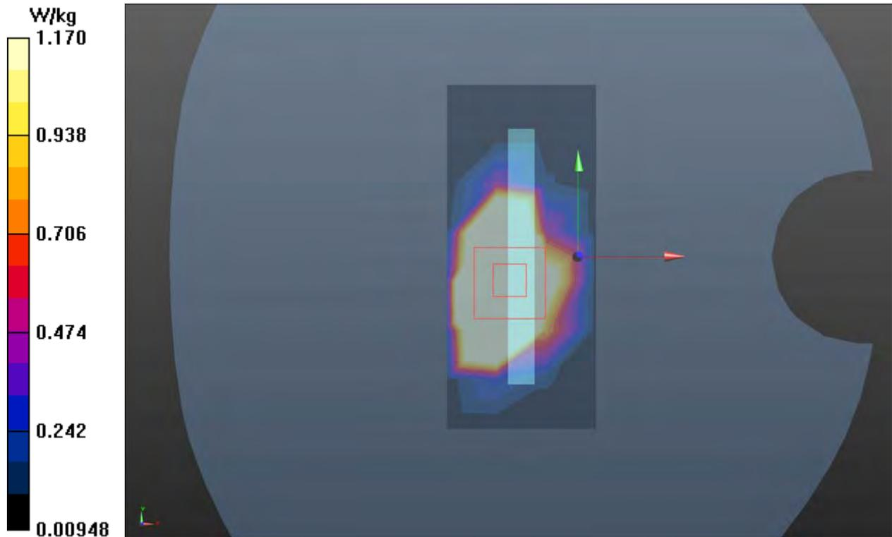
**Plot 62 LTE Band 5 1RB Back Side Low (Distance 10mm)**
