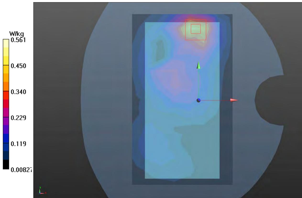
**Plot 43 LTE Band 4 50%RB Back Side Low (Distance 15mm)**
