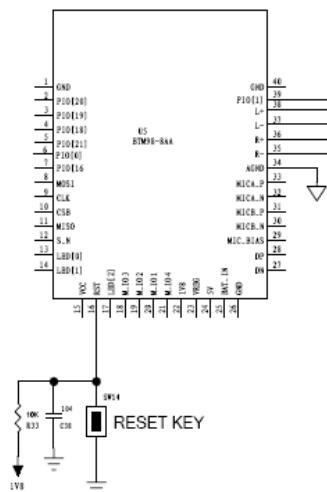
**Figure 2:** BTM98-8AA reset circuitry
