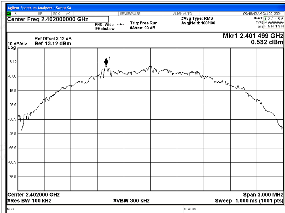
Tx. Spurious NVNT BLE 2M 2402MHz Ant Emission
