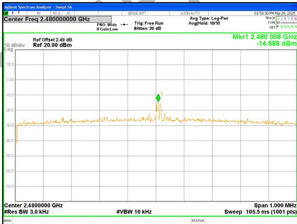
PSD NVNT BLE 2M 2480MHz Ant1
