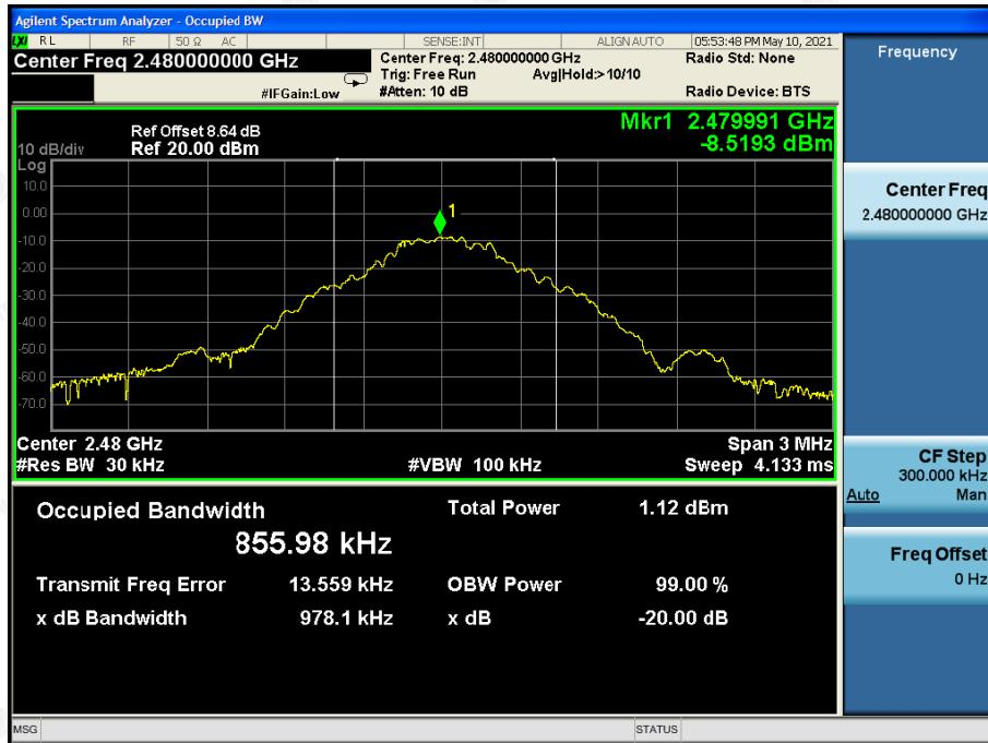
Test Mode:  $\pi/4$ DQPSK
